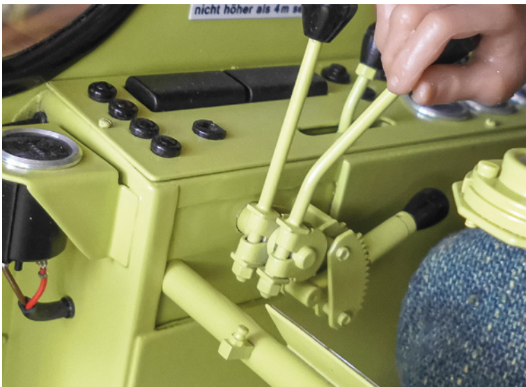
Der Hebel mit den Rastungen ist das Handgas
