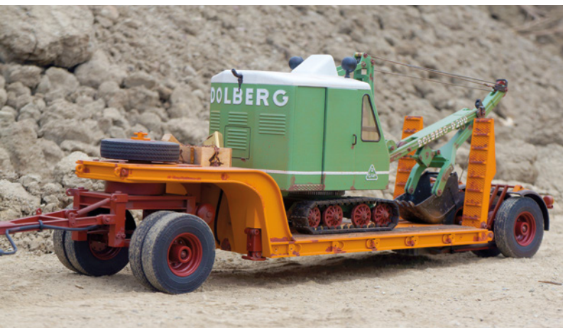
Zweiachs-Tieflader fahrbereit zum Abtransport des Dolberg D200
