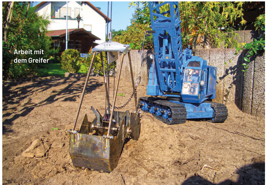
Der brünierte Greifer mit eingeschrirrtm Seil
