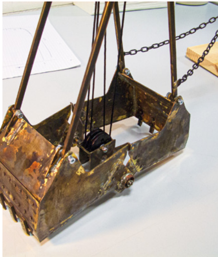
Der brünierte Greifer mit eingeschrirrtm Seil
