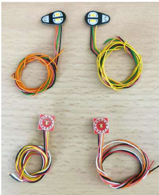
Beleuchtungsplatinen für den WA475-10 (Foto: Fumotec)
