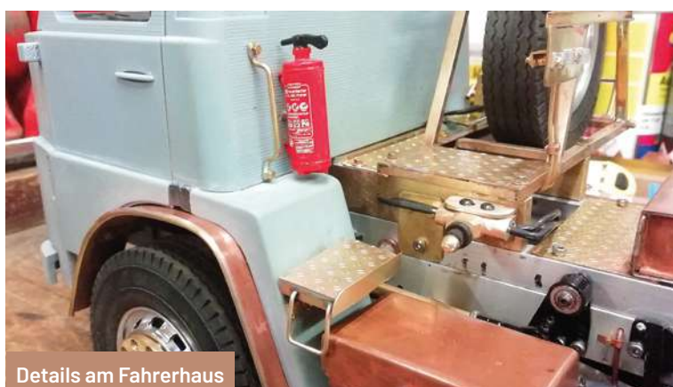
Die Radmutterchutzringe sind selbst gefertigt
