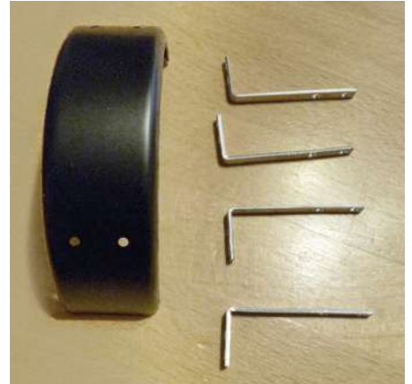
Die Halter für die Kotflügel wurden selbst angefertigt
