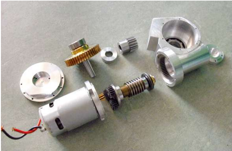
Das zerlegte Oberwagendrehwerk, ganz speziell mit nur einem, aber beidseitig wirkenden Axialkugellager (rechts neben Schnecke)
