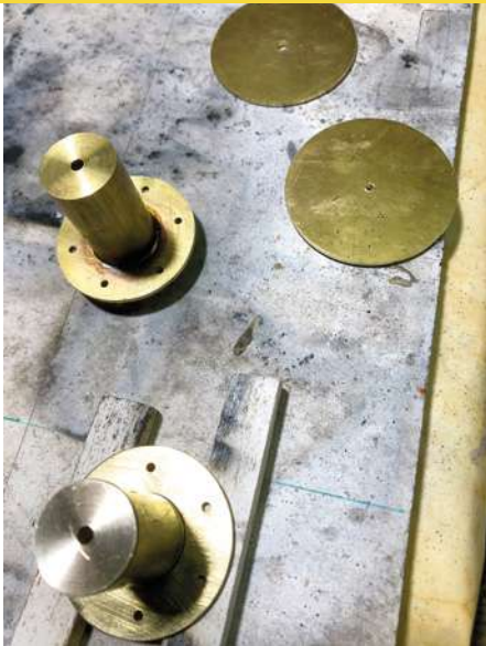
Die aus Messing gefertigten Reifenaufnahmen
