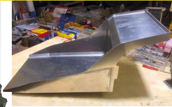
Die große Kippmulde besteht größtenteils aus Aluminium
