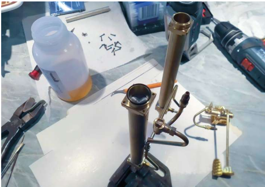
Auch die Montage der beiden Hubzylinder ist nur vom Fuß her möglich
