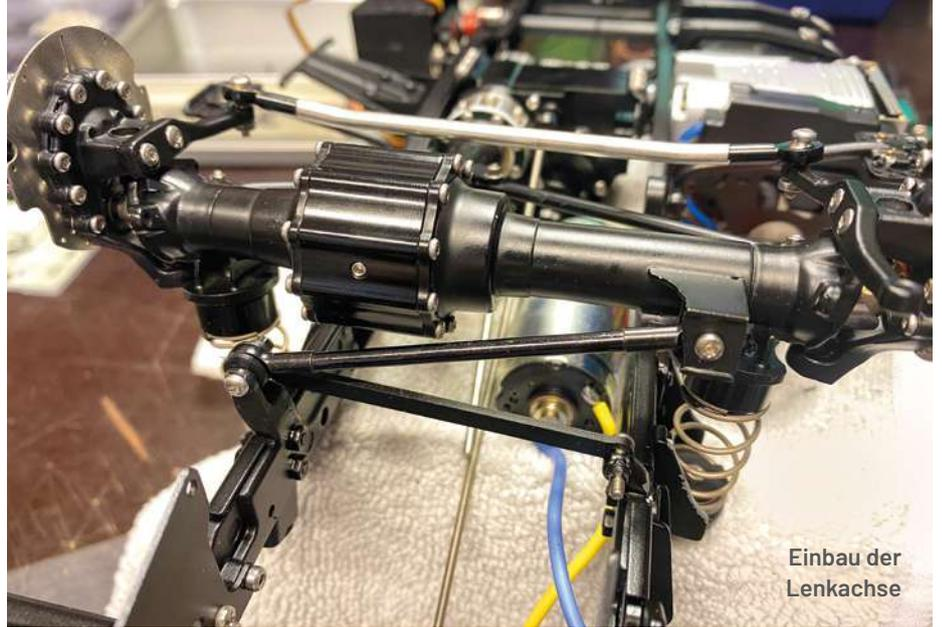
Einbau der Lenkachse
