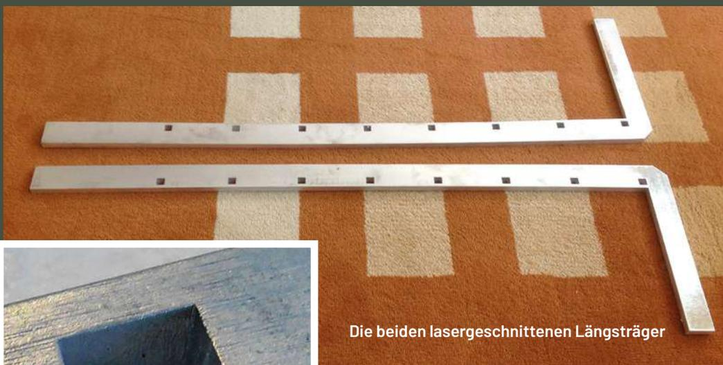
Die beiden lasergeschnittenen Längsträger
