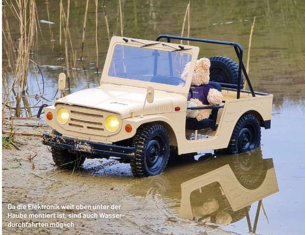
Da die Elektronik weit oben unter der Haube montiert ist, sind auch Wasserdurchfahrten möglich
