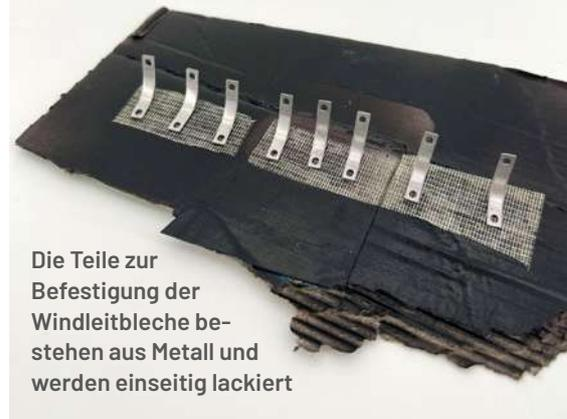
Die Teile zur Befestigung der Windleitbleche bestehen aus Metall und werden einseitig lackiert
