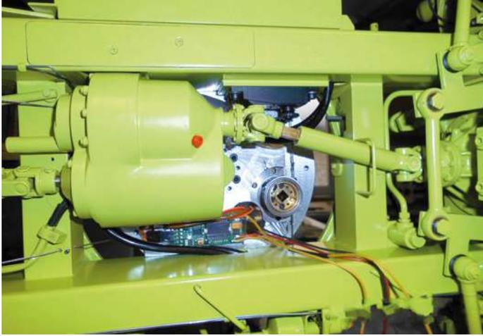
So schaut es von unten aus, wenn das Lenkgetriebe abmontiert ist. Die zweiteilige Seiltrommel inkl. Dünnringlager kommt zum Vorschein
