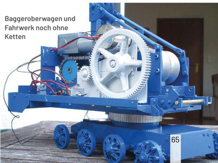
Baggeroberwagen und Fahrwerk noch ohne Ketten
