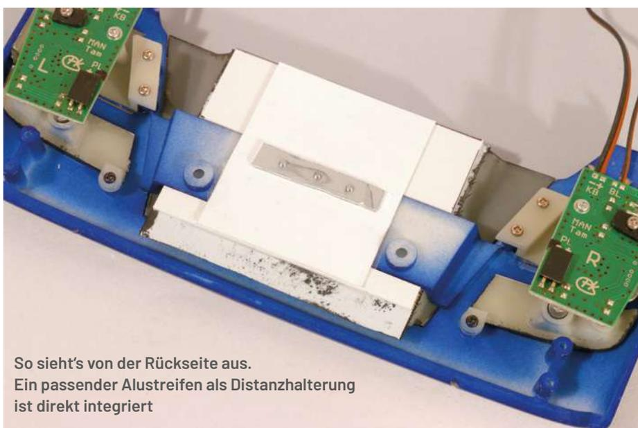
So sieht's von der Rückseite aus. Ein passender Alustreifen als Distanzhalterung ist direkt integriert
