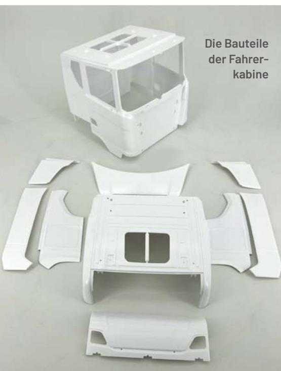
Die Bauteile der Fahrerkabine
