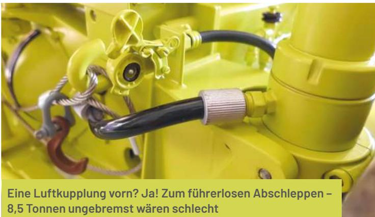
Eine Luftkupplung vorn? Ja! Zum führerlosen Abschleppen – 8,5 Tonnen ungebremst wären schlecht
