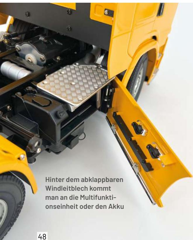
Hinter dem abklappbaren Windleitblech kommt man an die Multifunktionseinheit oder den Akku
