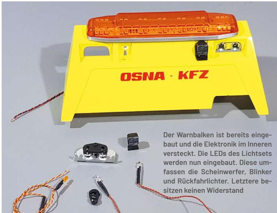
Der Warnbalken ist bereits eingebaut und die Elektronik im Inneren versteckt. Die LEDs des Lichtsets werden nun eingebaut. Diese umfassen die Scheinwerfer, Blinker und Rückfahrlichter. Letztere besitzen keinen Widerstand
