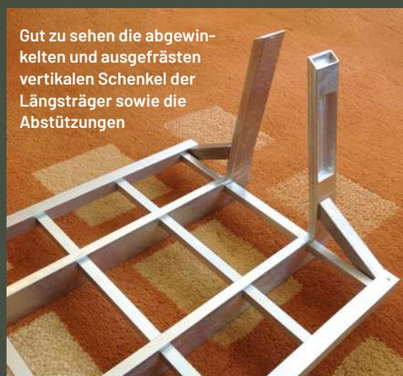
Gut zu sehen die abgewinkelten und ausgefrästen vertikalen Schenkel der Längsträger sowie die Abstützungen
