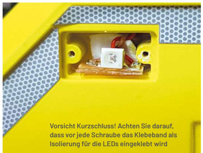
Vorsicht Kurzschluss! Achten Sie darauf, dass vor jede Schraube das Klebeband als Isolierung für die LEDs eingeklebt wird
