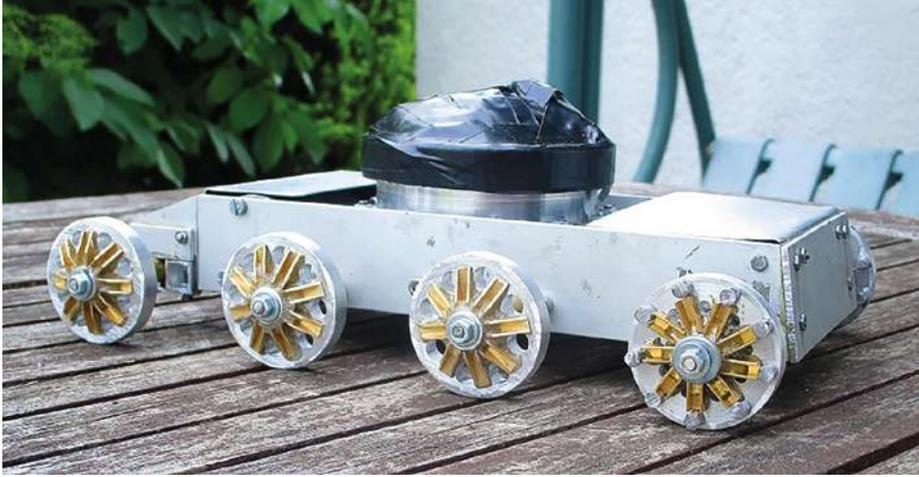
Fahrwerk des Baggers mit umgearbeiteten Laufrollen
