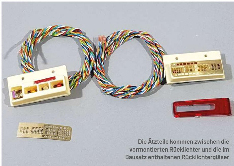
Die Ätzteile kommen zwischen die vormontierten Rücklichter und die im Bausatz enthaltenen Rücklichtergläser
