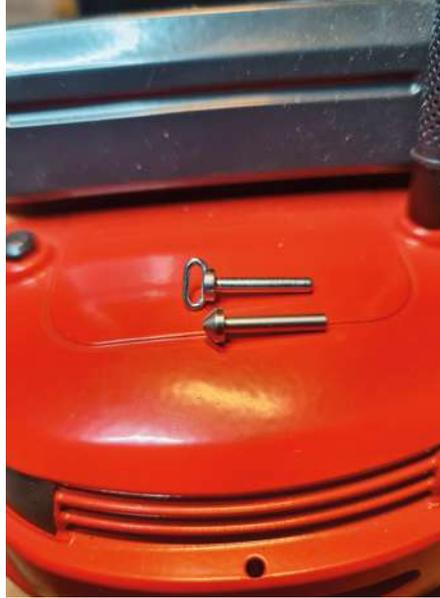
▲ Eine kleine Öse mit großer Wirkung. Dank des Handgriffes fällt die Bedienung der Anhängerkupplung nun deutlich leichter
