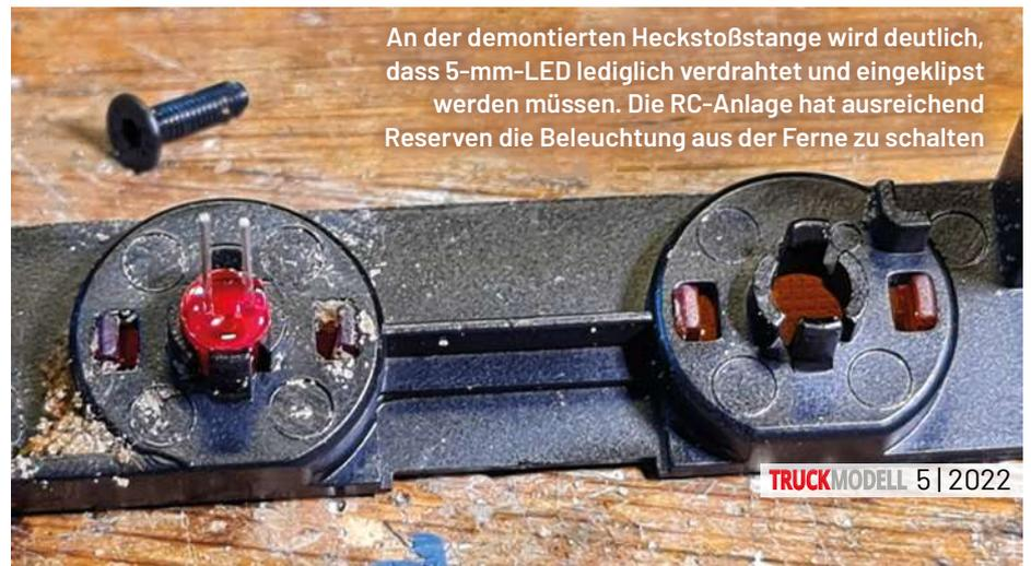
An der demontierten Heckstoßstange wird deutlich, dass 5-mm-LED lediglich verdrahtet und eingeklipst werden müssen. Die RC-Anlage hat ausreichend Reserven die Beleuchtung aus der Ferne zu schalten
