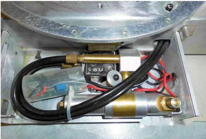
▲ Das elektrohydraulische Niveausperrventil der Vorderachse benötigt 24 Volt, welche der Spannungswandler aus 12 Volt erzeugt. Das größere, längliche, runde Bauteil, ist im Prinzip ein Hydraulikzylinder, mit per Gewindespindel verstellbarem Kolben. Damit lässt sich die Bodenfreiheit an der Vorderachse ganz einfach justieren
