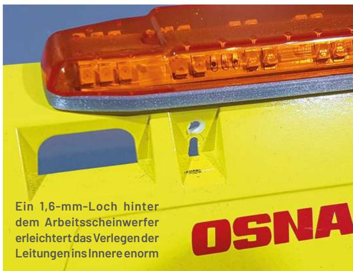
Ein 1,6-mm-Loch hinter dem Arbeitsscheinwerfer erleichtert das Verlegen der Leitungen ins Innere enorm
