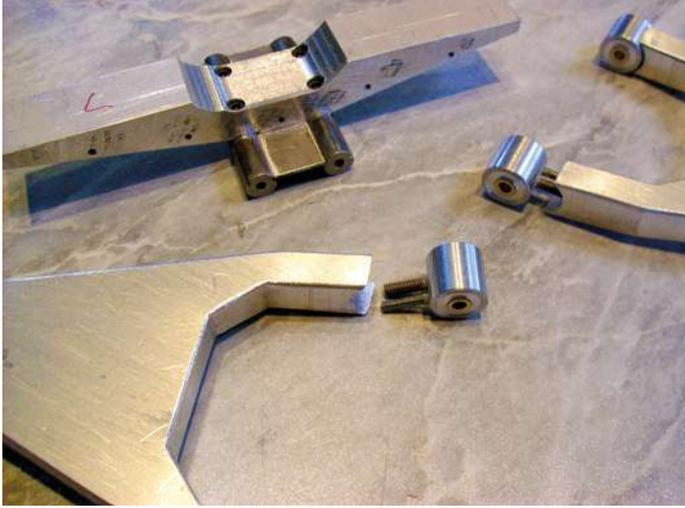
Die Gewindezapfen der Lagerhülsen ankeren, später verklebt, in nächst größeren Innengewinden der Dreieckslenker
