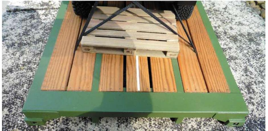
Der weiße Mittelstreifen dient zur Orientierung bei der Beladung
