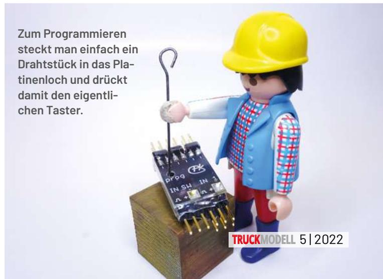
Zum Programmieren steckt man einfach ein Drahtstück in das Platinenloch und drückt damit den eigentlichen Taster.
