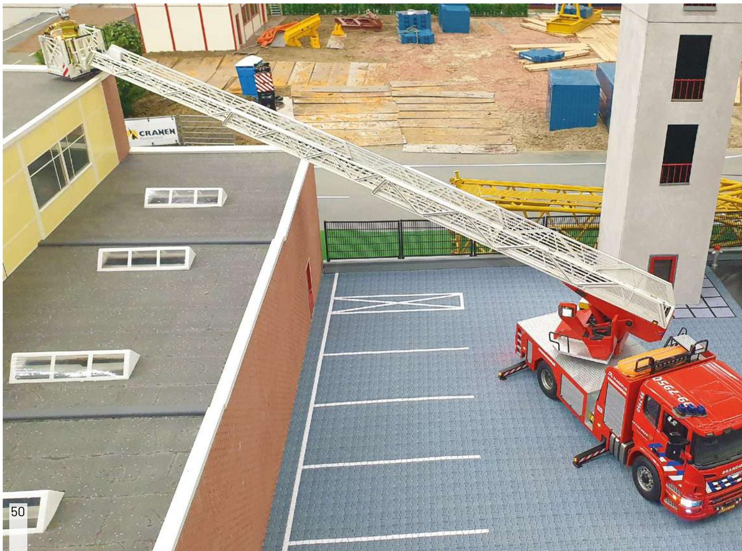
7,4 Volt brachte. Der Boden des Korbes wurde 5 mm höher gelegt, um die Verdrahtung unterzubringen und an der Unterseite wurde eine neue Bodenplatte angefertigt und angebracht.
