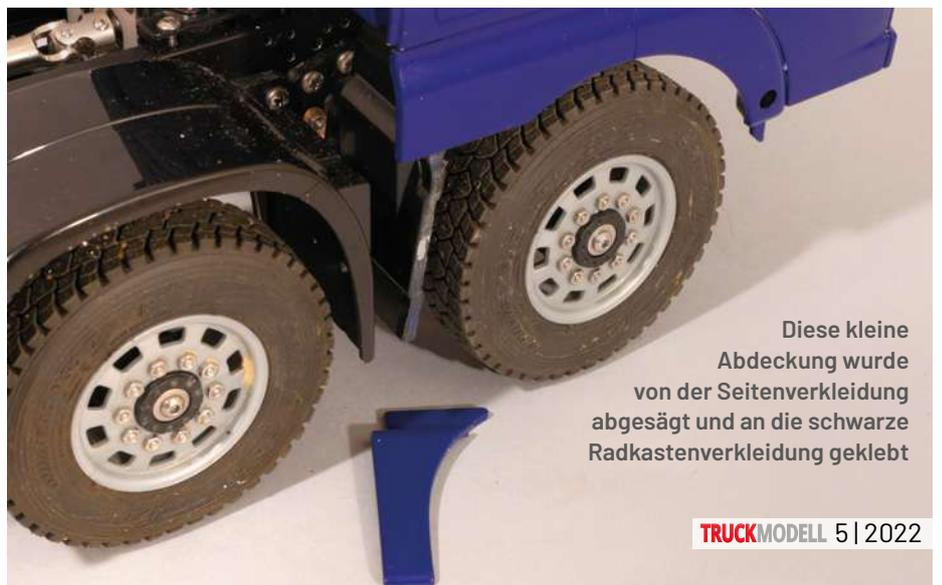
Diese kleine Abdeckung wurde von der Seitenverkleidung abgesägt und an die schwarze Radkastenverkleidung geklebt
