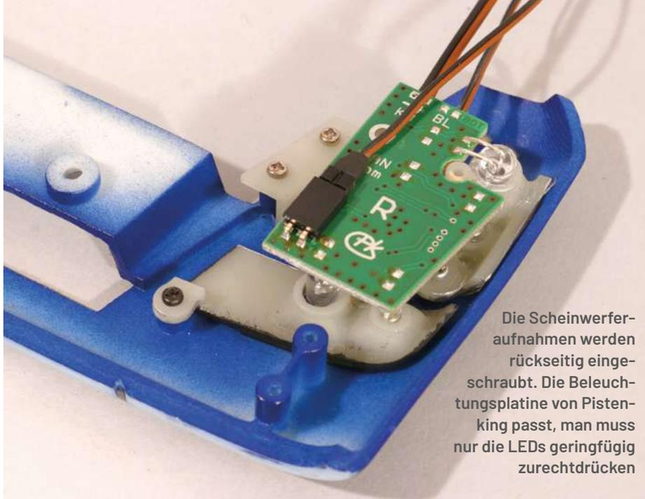
Die Scheinwerferaufnahmen werden rückseitig eingeschraubt. Die Beleuchtungsplatine von Pistenking passt, man muss nur die LEDs geringfügig zurecht drücken
