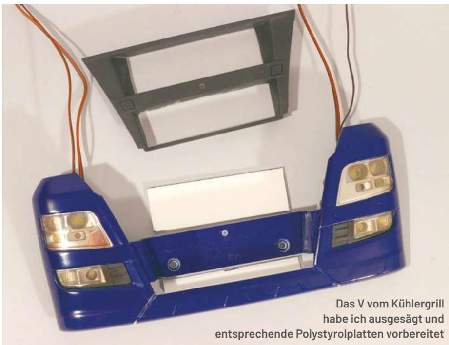
Das V vom Kühlergrill habe ich ausgesägt und entsprechende Polystyrolplatten vorbereitet
