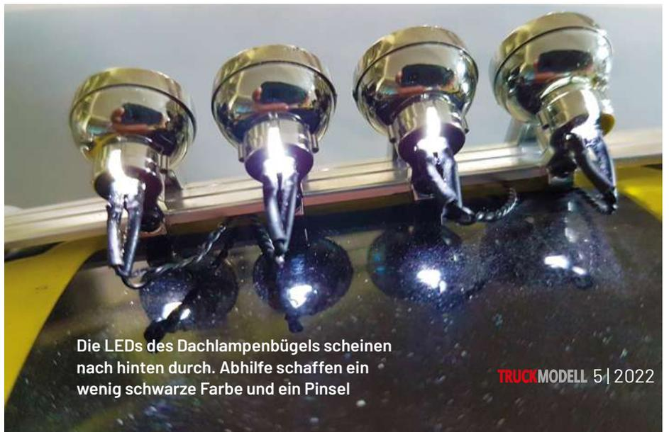
Die LEDs des Dachlampenbügels scheinen nach hinten durch. Abhilfe schaffen ein wenig schwarze Farbe und ein Pinsel
