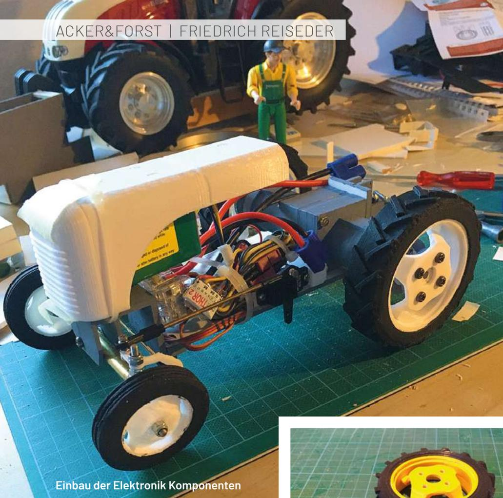
Einbau der Elektronik Komponenten
