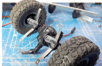
Später wurden zusätzliche Federn ergänzt, die das Fahrverhalten deutlich verbessern
