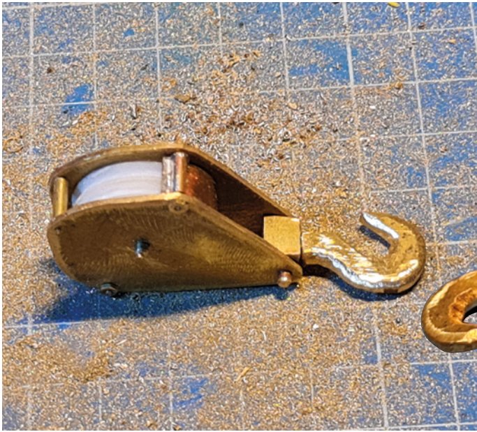
Die erste Version des Hakens mit zwei gedruckten Seilscheiben gefiel mir eigentlich sehr gut, leider funktionierte sie nicht. Der Haken war einfach zu leicht für den doppelten Flaschenzug
