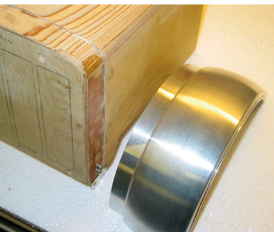
Motorhaube mit Kotflügel aus Aluminium
