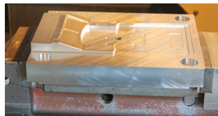
Eine der Spritzgussformen auf der CNC-Maschine während der Endbearbeitung
