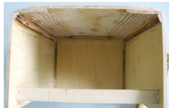
Innenansicht der Motorhaube mit geschliffenen Radien
