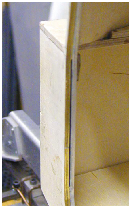
Türfalz mit Schlitz zum Einstecken des Scharniers
