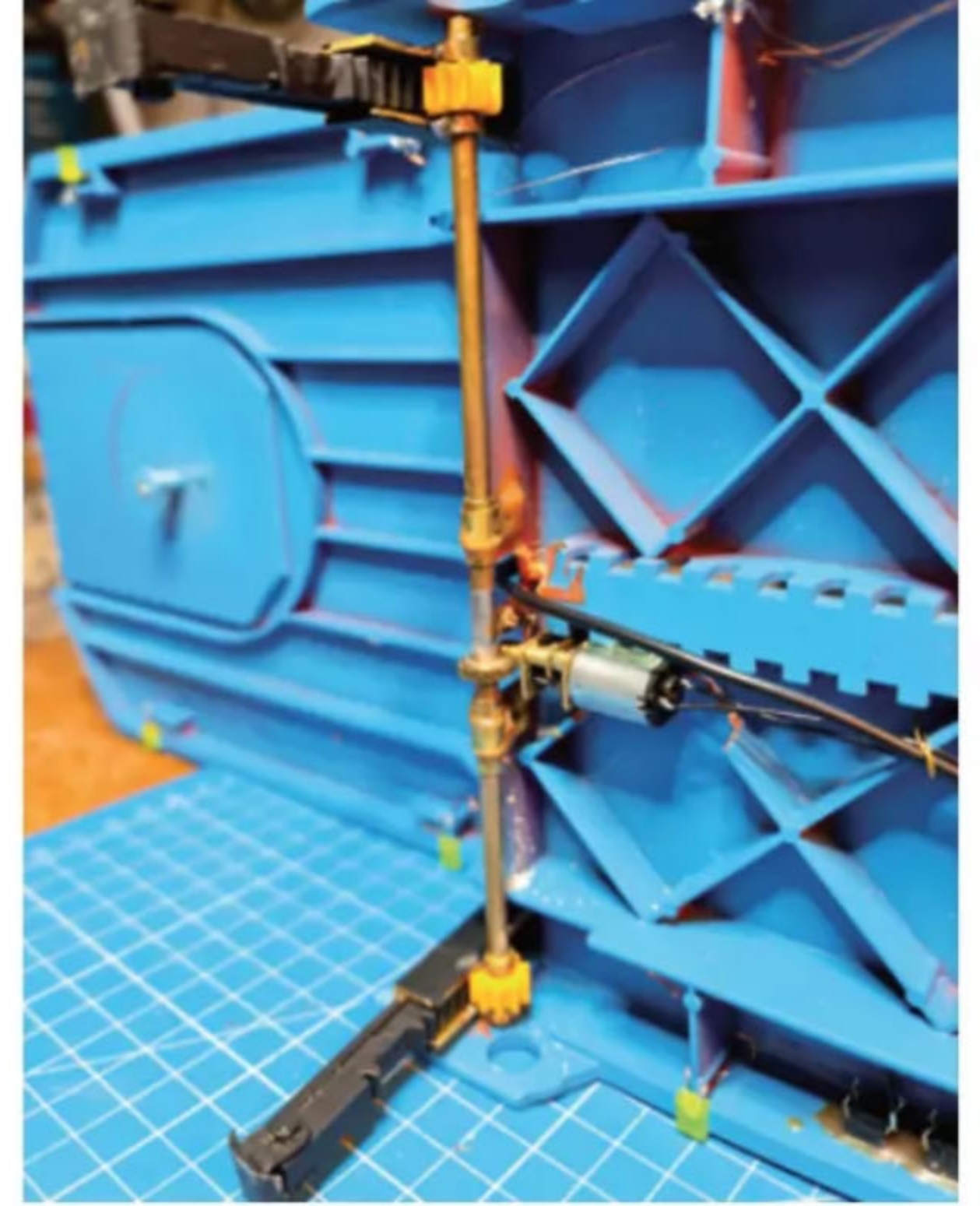
Um die Aufliegerstützen zu motorisieren, installierte ich einen Getriebemotor, der über einen Welle beide Stützen antreibt
