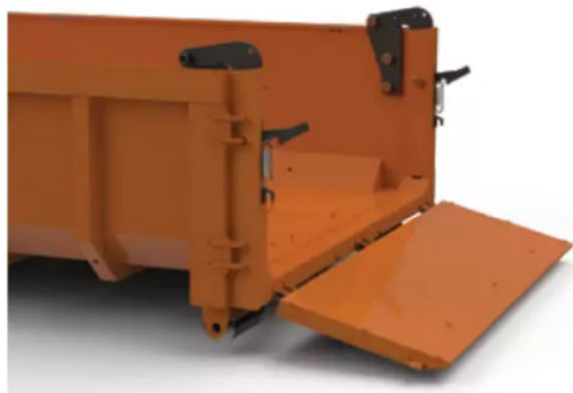
Die Heckklappe kann als Auffahrrampe dienen... (Foto: ScaleART)
