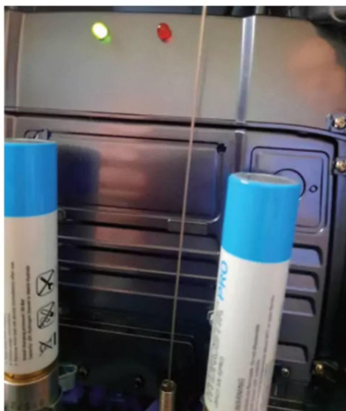
Die beiden Kontroll-LEDs wurden nach den ersten Tests oben in die Rückwand integriert
