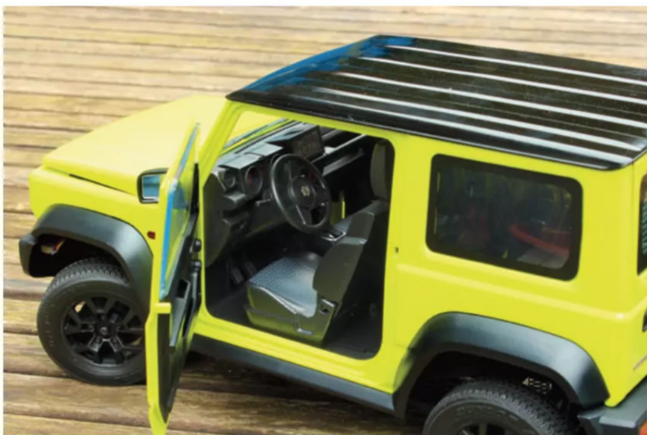
Nette Sonderfunktion – das Lenkrad dreht dank eigenem Servo mit
