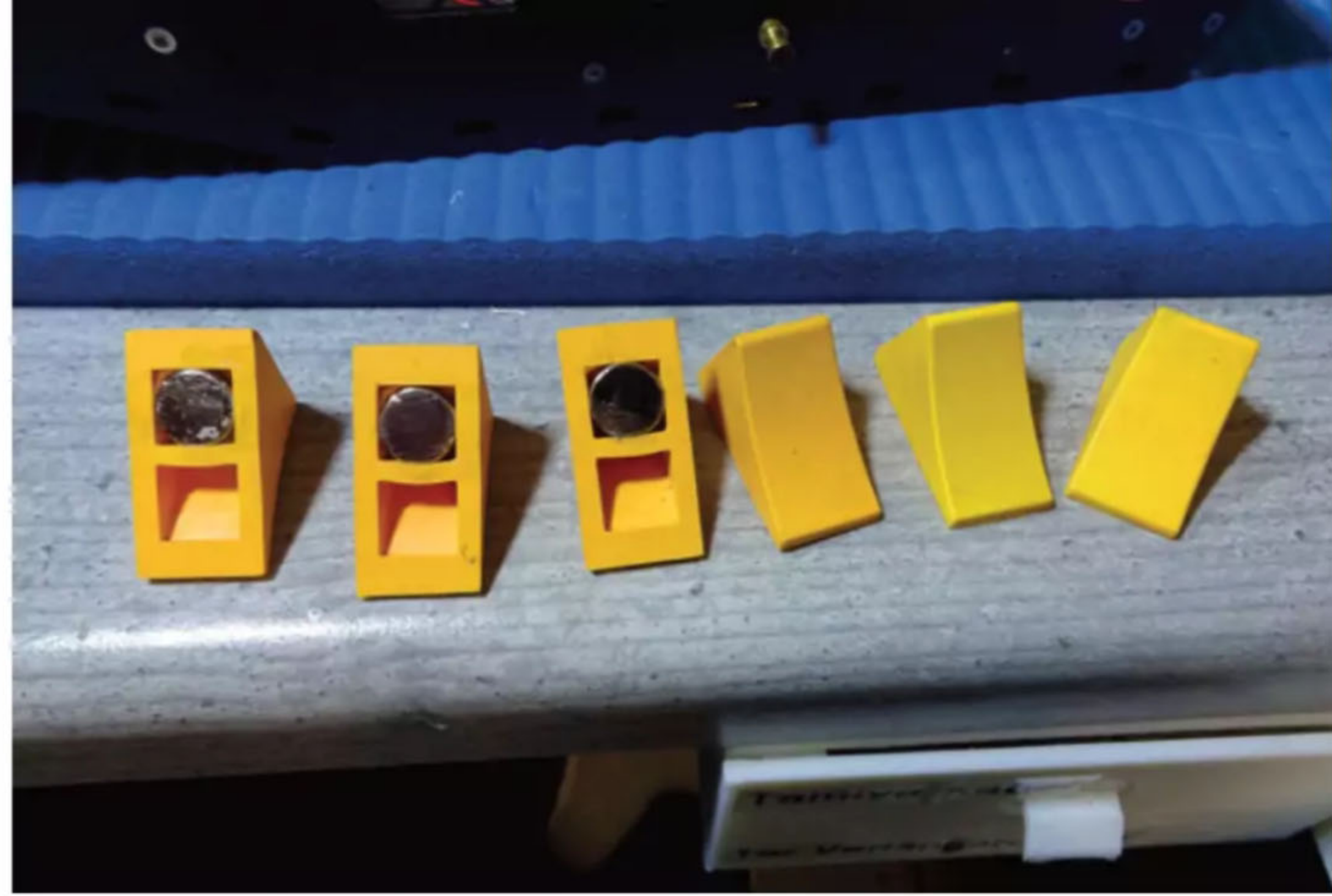
Die Bremskeile werden von starken Neodym-Magneten gehalten
