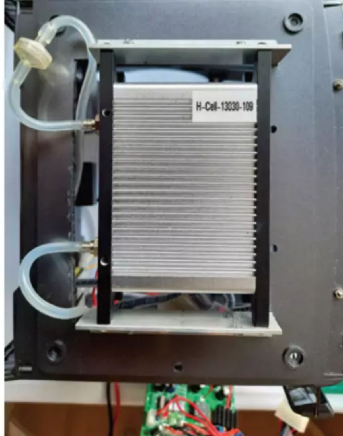
Die Brennstoffzelle sitzt beim Truckmodell in einer Aussparung im Dach
