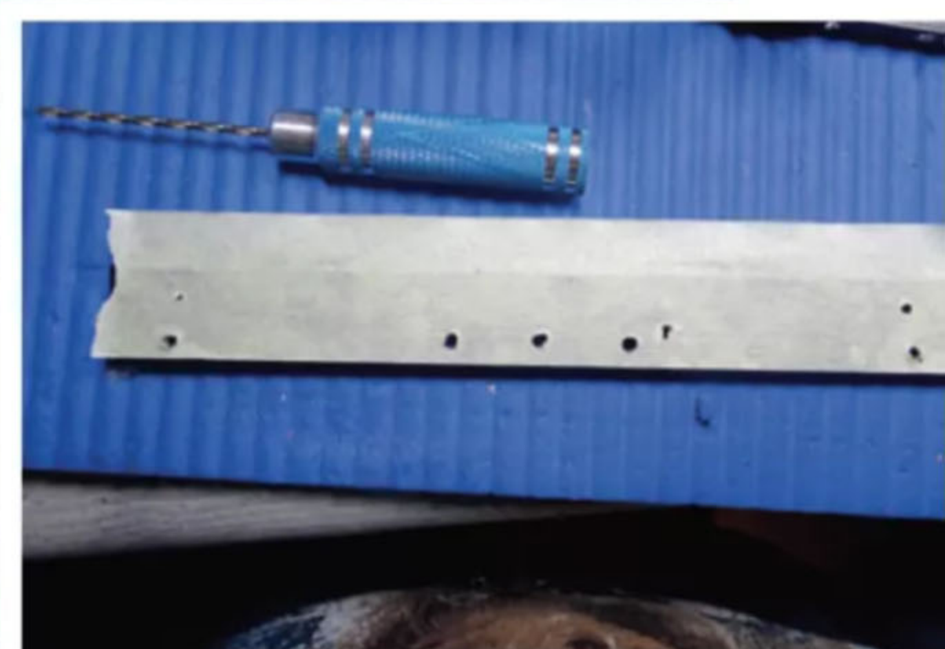
▲ Die Übertragung der Bohrungen erfolgte mittels Klebeband
