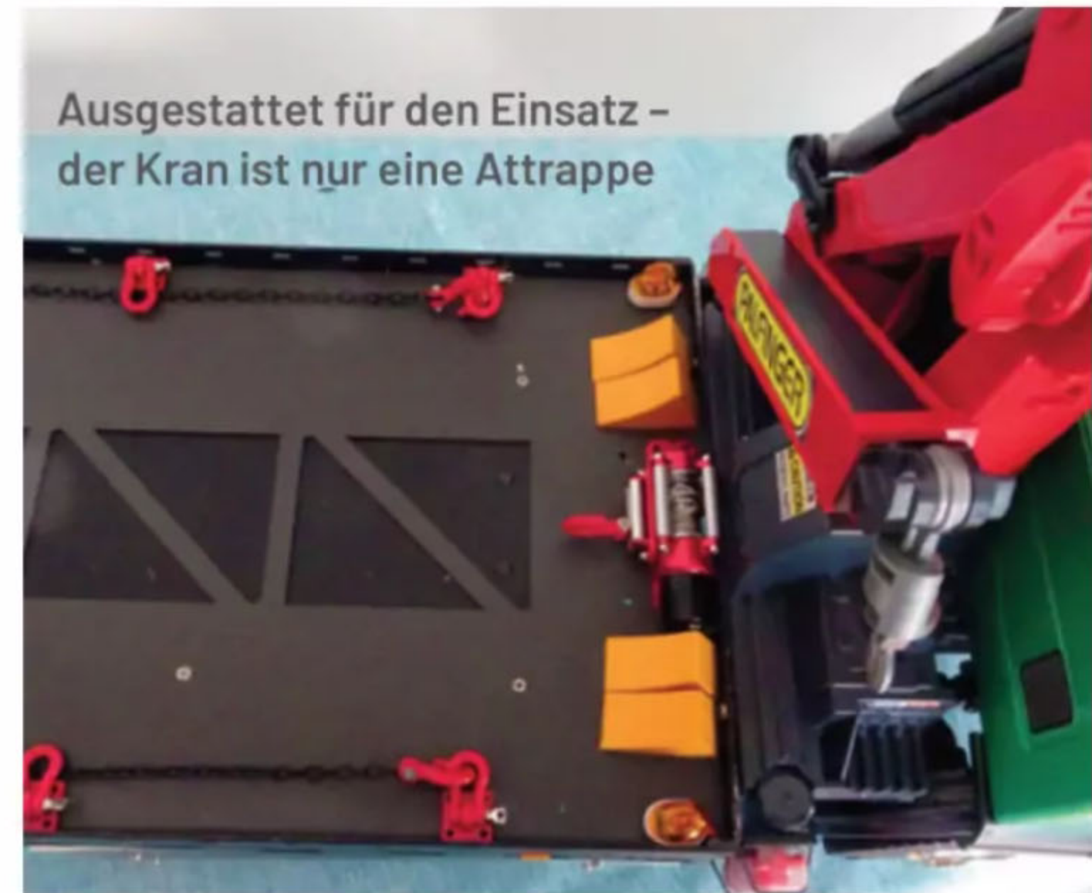
Die Bremskeile werden von starken Neodym-Magneten gehalten
