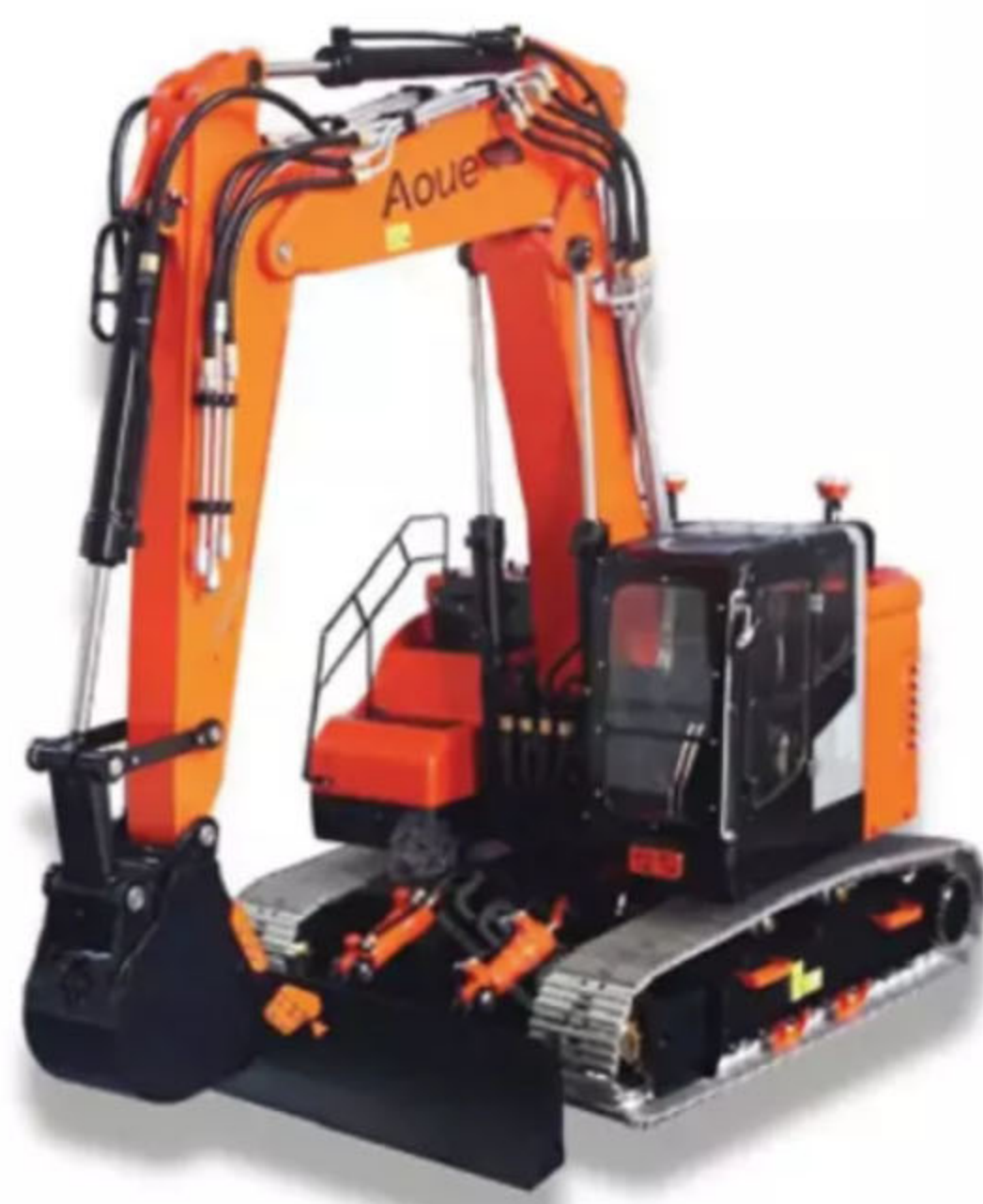
Der neue Kurzheckbagger mit Verstellausleger und Räumschild. Die Lieferung erfolgt unlackiert (Foto: thicon)
