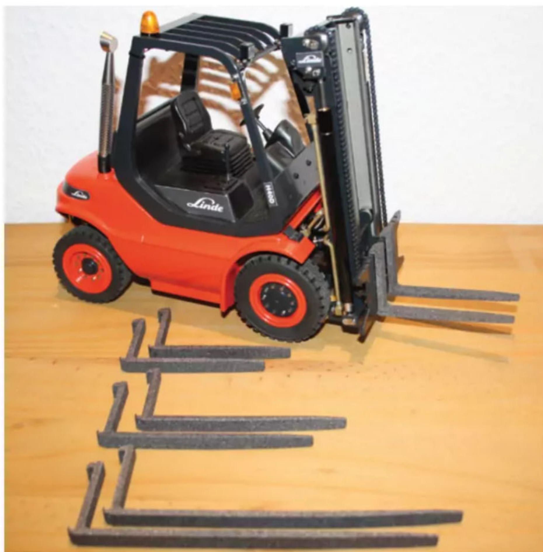
Die neuen Gabelzinken für den Lesu-Gabelstapler und ähnliche Modelle bestehen aus Alumide (Foto: TMV)
