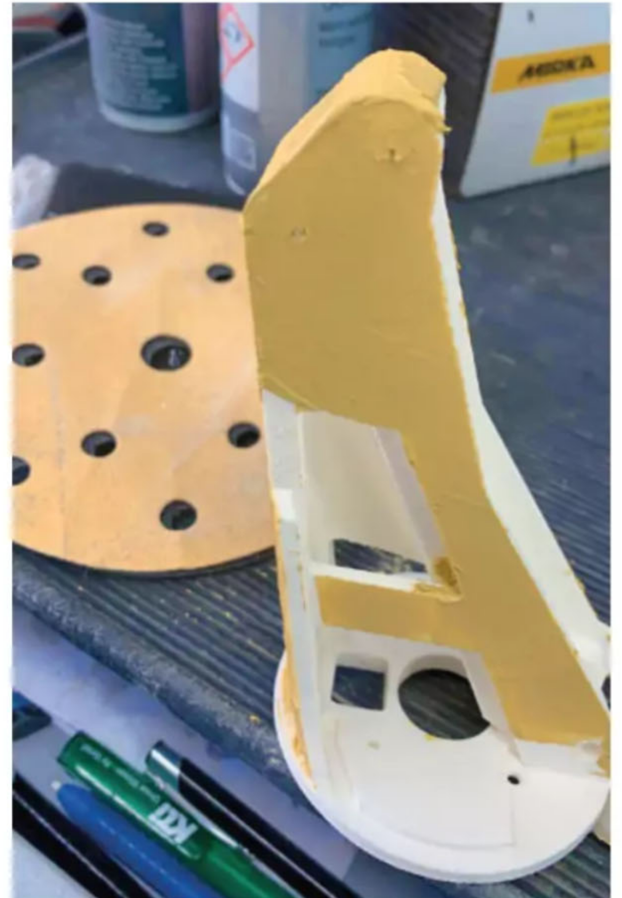
Die Kranteile aus dem 3D-Drucker wurden ausführlich gespachtelt und geschliffen
