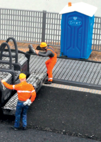
Die Arbeitsbohlen in Arbeits- und Transportstellung.
