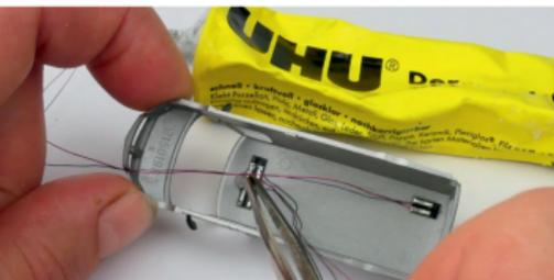
Die Trägerplatinen mit den blauen LEDs und den Kabeln werden von innen einfach unter dem Fahrzeugdach verklebt. Die LEDs scheinen dabei durch die neu angefertigten Bohrungen.
