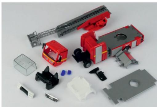
Anstelle einzelner LEDs mit Trägerplatte kommen bei dem Feuerwehrmodell vorverkabelte SMD-LEDs von Viessmann zum Einsatz. Nach dem Zerlegen des Modells sind alle Bereiche gut erreichbar. Die Einzelteile sind nur gesteckt und können leicht voneinander getrennt werden.
