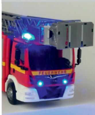
Als Blitzer-LEDs können ebenfalls die 0603er-LEDs von Viessmann eingesetzt werden. Filigraner ist die hier verwendete, etwas kleinere SMD-Bauform 0402. Die genaue Position der hinteren Leuchten variiert beim Original von Fahrzeug zu Fahrzeug.
