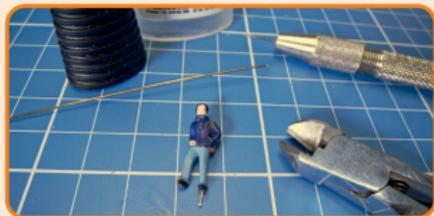
In die Füße der Figuren werden 0,5 mm große Löcher gebohrt und mit einem Messingdraht versehen. An entsprechender Stelle auf dem Diorama wird ebenfalls ein Loch gebohrt und die Figur eingesetzt. Das gibt den Figuren im Schnee einen sicheren Stand. Sollte eine Figur beim Fotografieren des Dioramas mal stören, wird sie einfach weggenommen.
