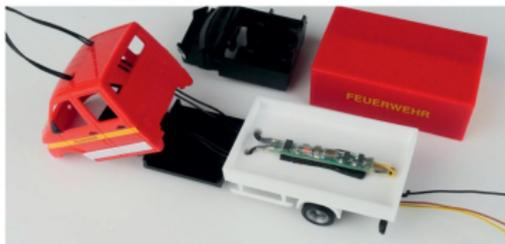
Die Steuerelektronik mit den beiden unabhängig voneinander angesteuerten Lichtausgängen findet aufgrund der kleinen Abmessungen praktischerweise direkt auf der Ladefläche unter der Plane Platz. Die Befestigung gelingt mit doppelseitigem Klebeband oder ähnlichem.
