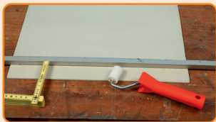
Auf der Basis von Polypur-Schaumplatten von Microrama lassen sich Pflasterstraßen individuell herstellen. Mit Druck prägt man die Pflasterstruktur mit Hilfe des Rollenstempels in die Platte.
