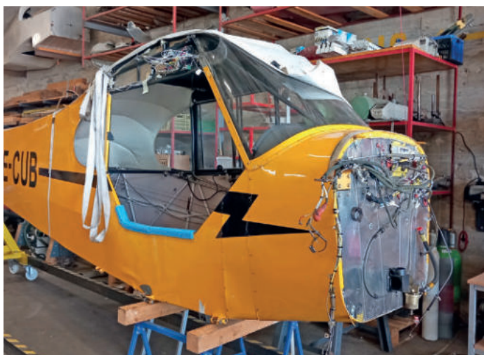
Die Piper PA-18 Super Cub muss nach einem glimpflich verlaufenen Unfall mühsam wieder instandgesetzt werden.
