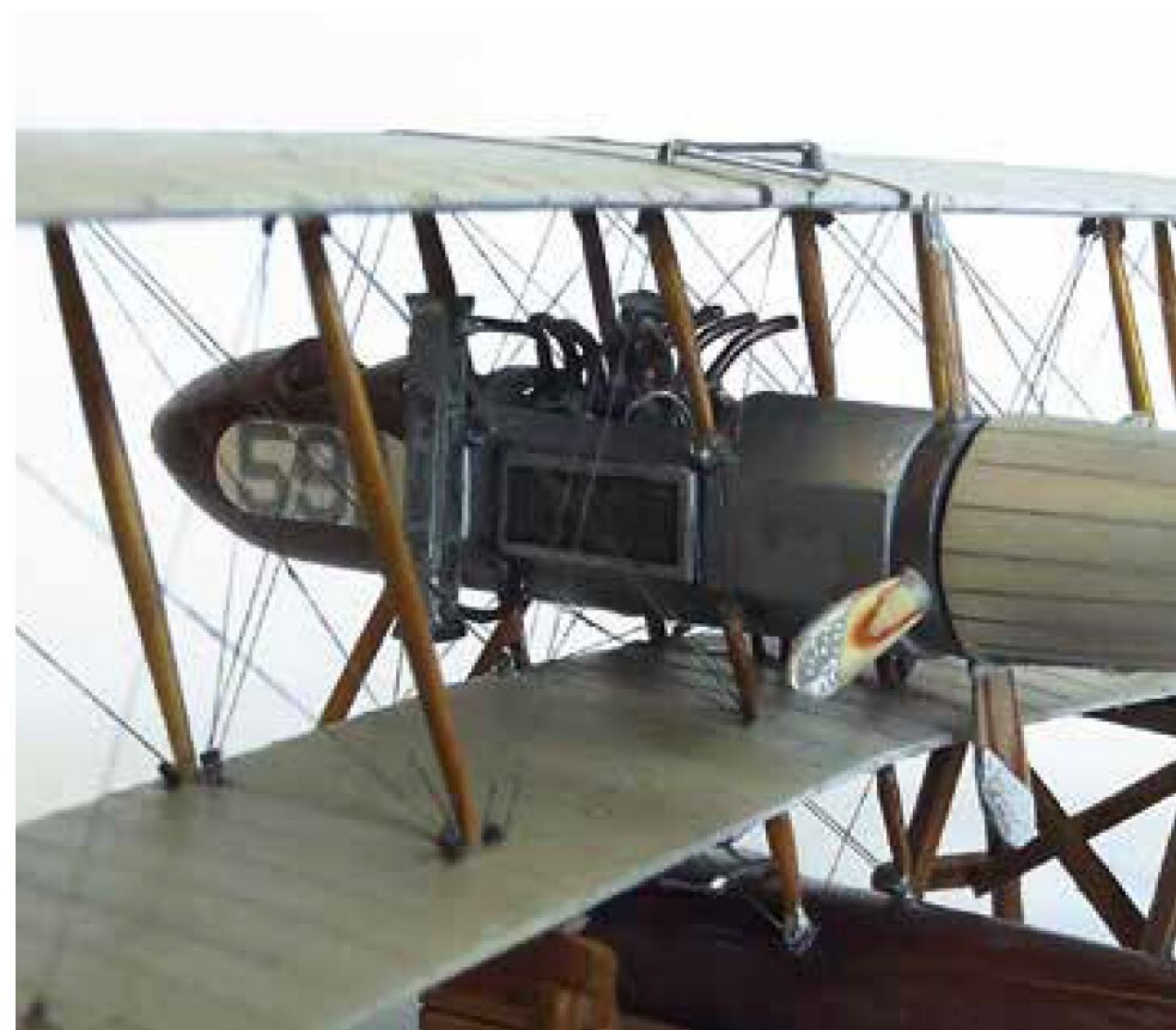
Die Anordnung des Propellers und der Motoren – und viele Spanndrähte.
