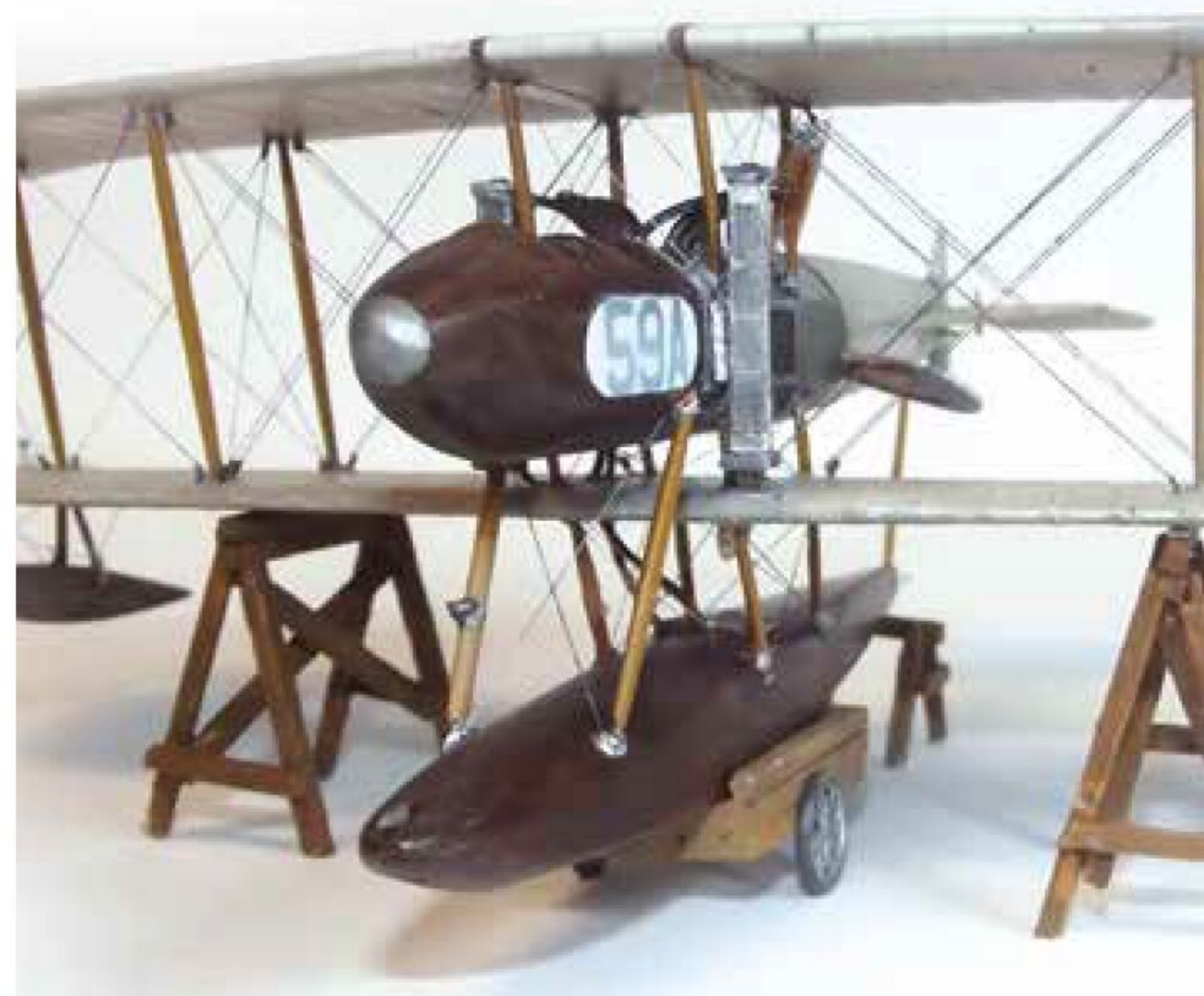
Man sieht, dass die zusätzlichen Kühler eine nachträgliche Notlösung waren.
