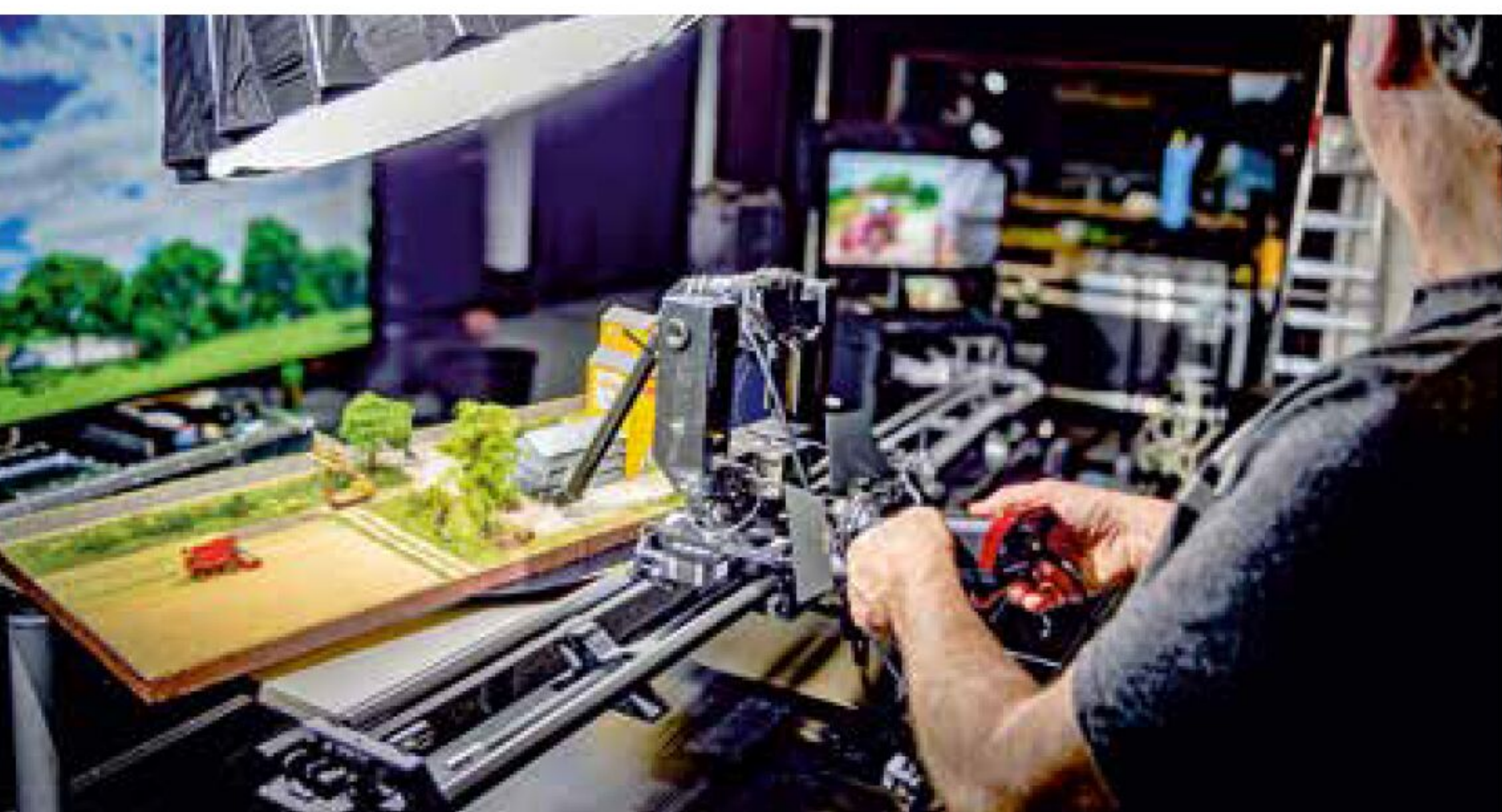
Die Makro-Spezialkamera ist auf einem automatischen Kameradolly installiert, der per Computer gesteuert wird. Damit werden millimetergenaue Kamerafahrten knapp über der Oberfläche realisiert.
