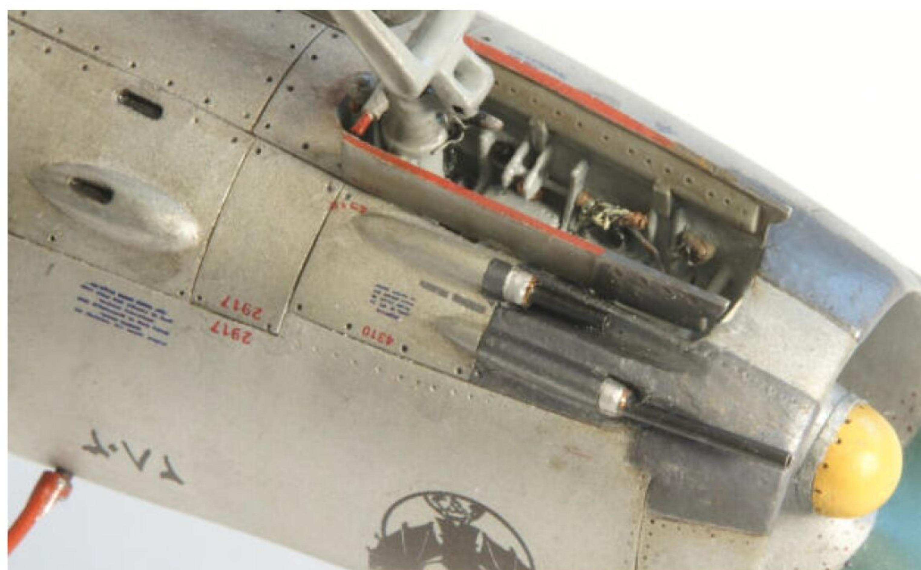
Entsprechend der geänderten Bewaffnung galt es auch die „gun blast panels“ samt den Auswurföffnungen zu überarbeiten.
