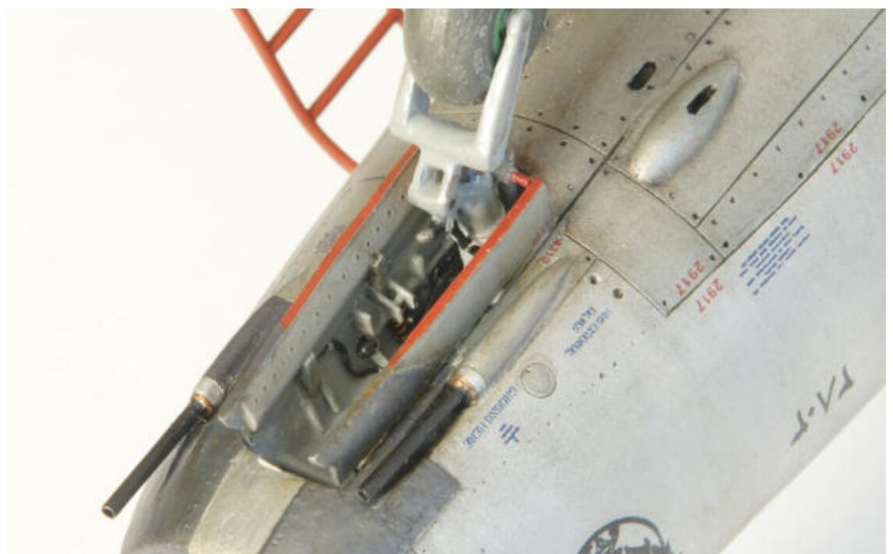
Die 37 mm-Kanone der MiG-17F wurde durch eine dritte vom Kaliber 23 mm ersetzt.
