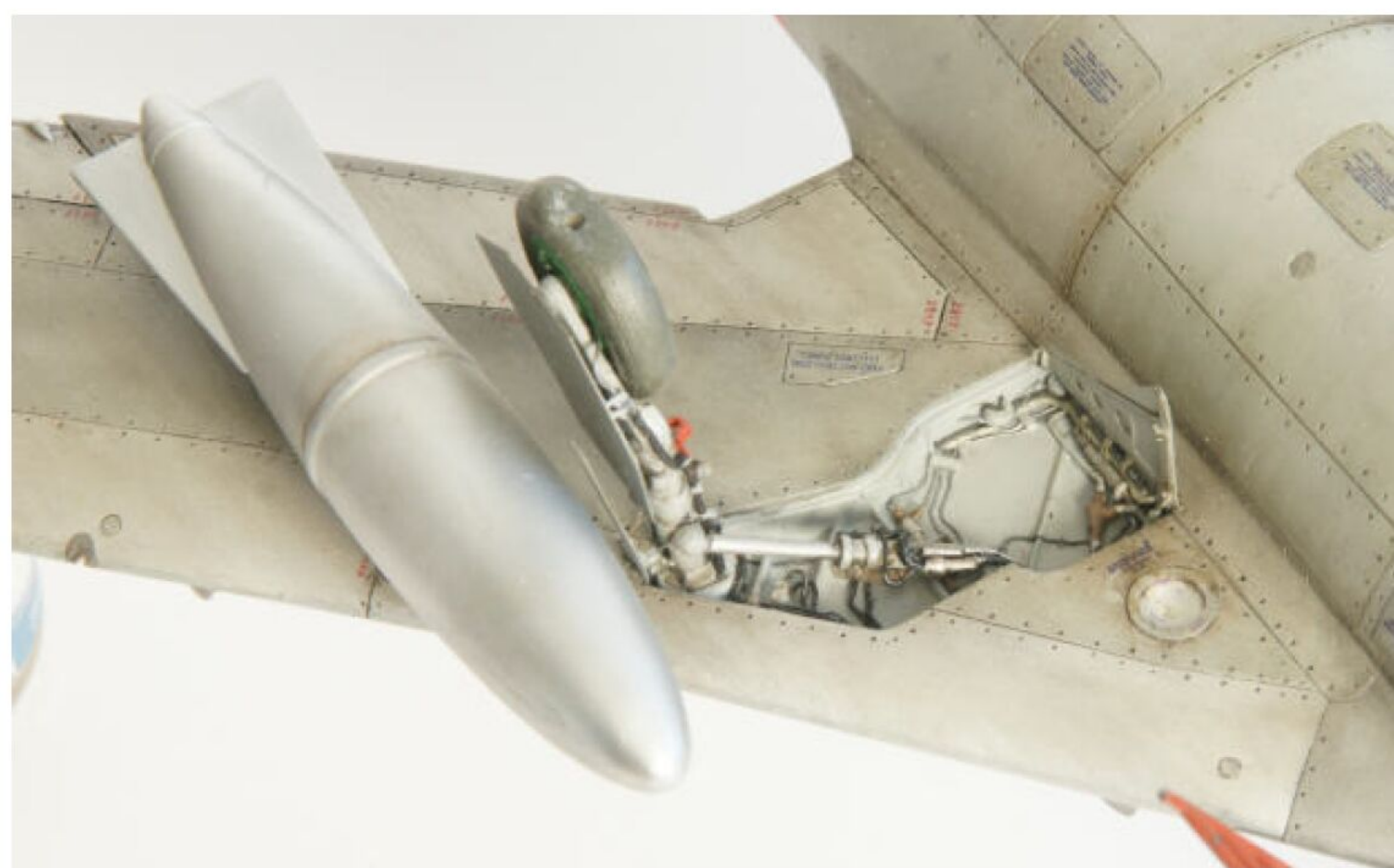
Blick auf den „Leitungssalat“ im Schacht des Hauptfahrwerks und auf den Landescheinwerfer.
