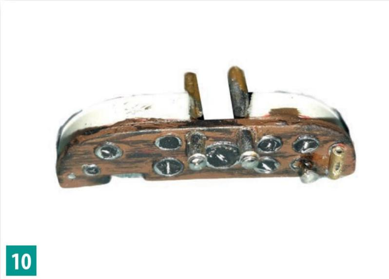
Den Brennstoffüberlauf auf der Instrumententafel ersetzte ich ebenfalls durch ein aufgefälltes Messingröhrchen.
