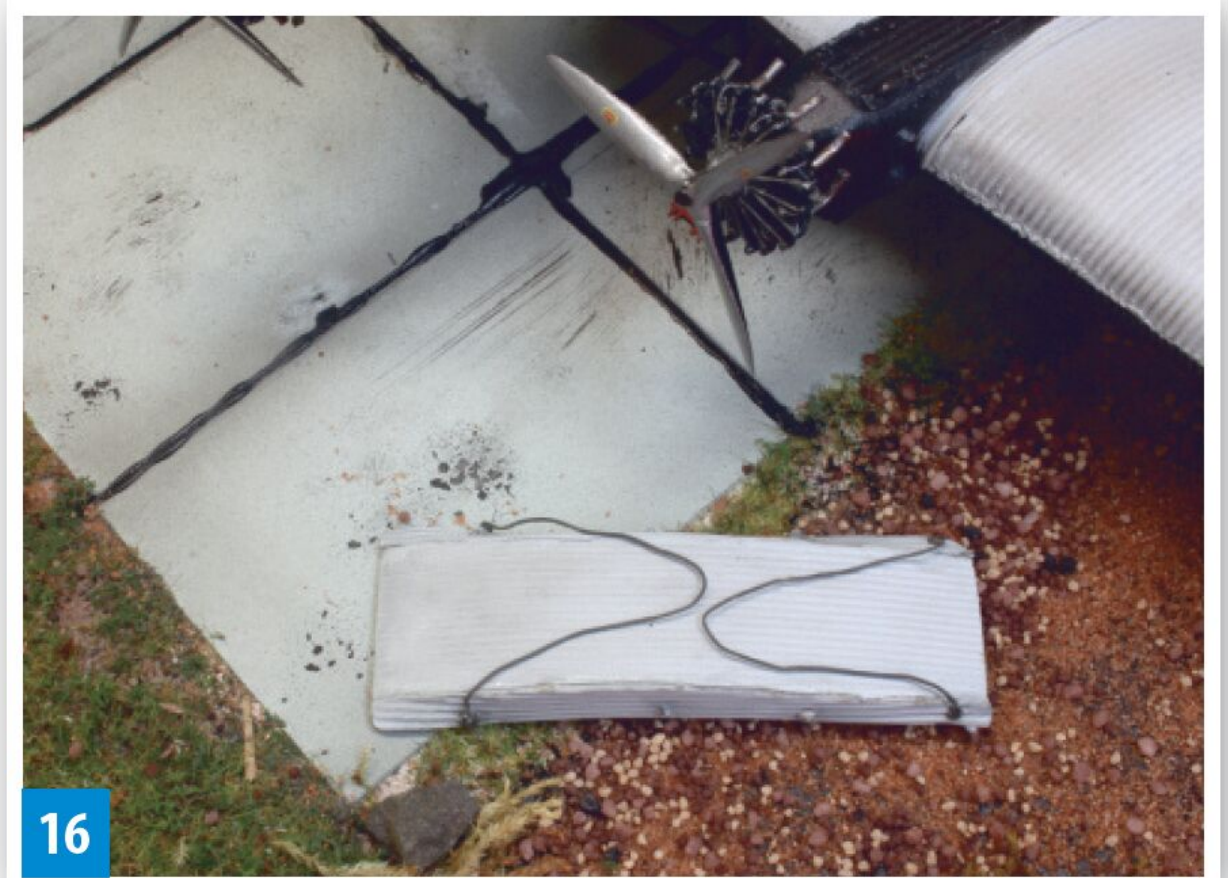
Der Deckel für die Ladeluke liegt neben dem Flieger, mit den Seilen zum Aufsetzen durch den Kran vorbereitet.
