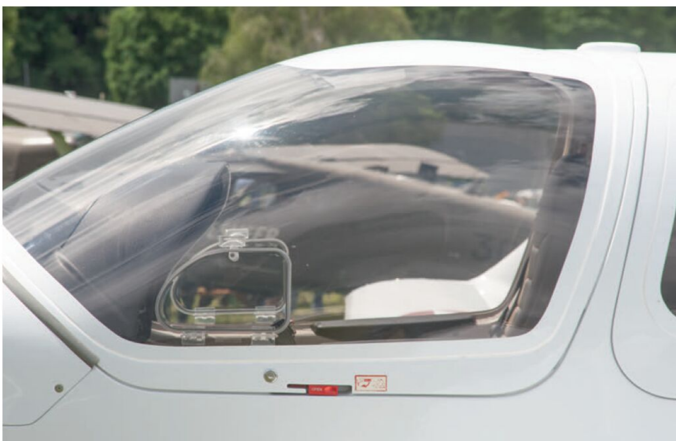
Lüftungsfenster und Cockpitverriegelung im Detail.
