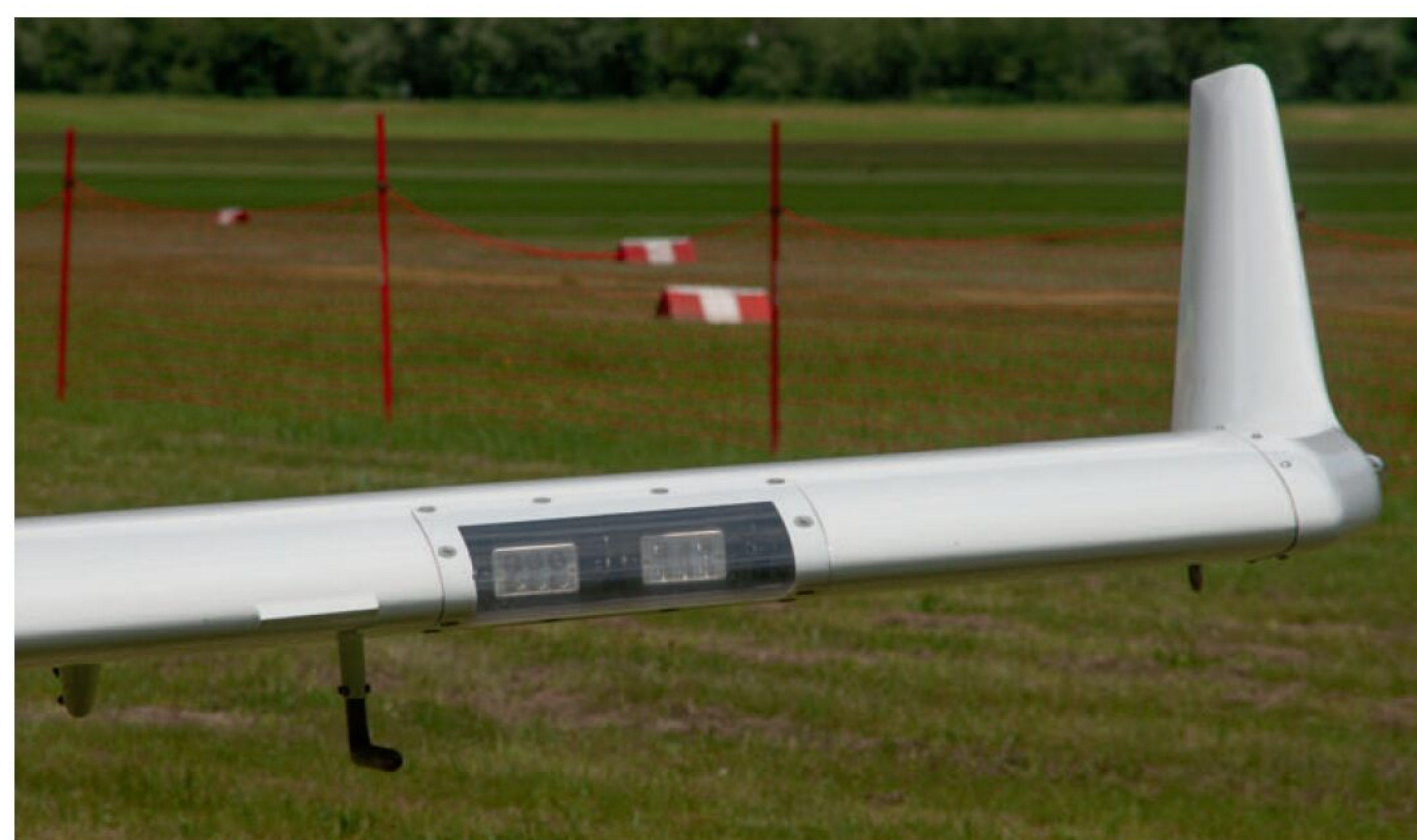
Landescheinwerfer mit LED-Bestückung. Wenn ich das Foto nur schon beim Bau gehabt hätte ...!
