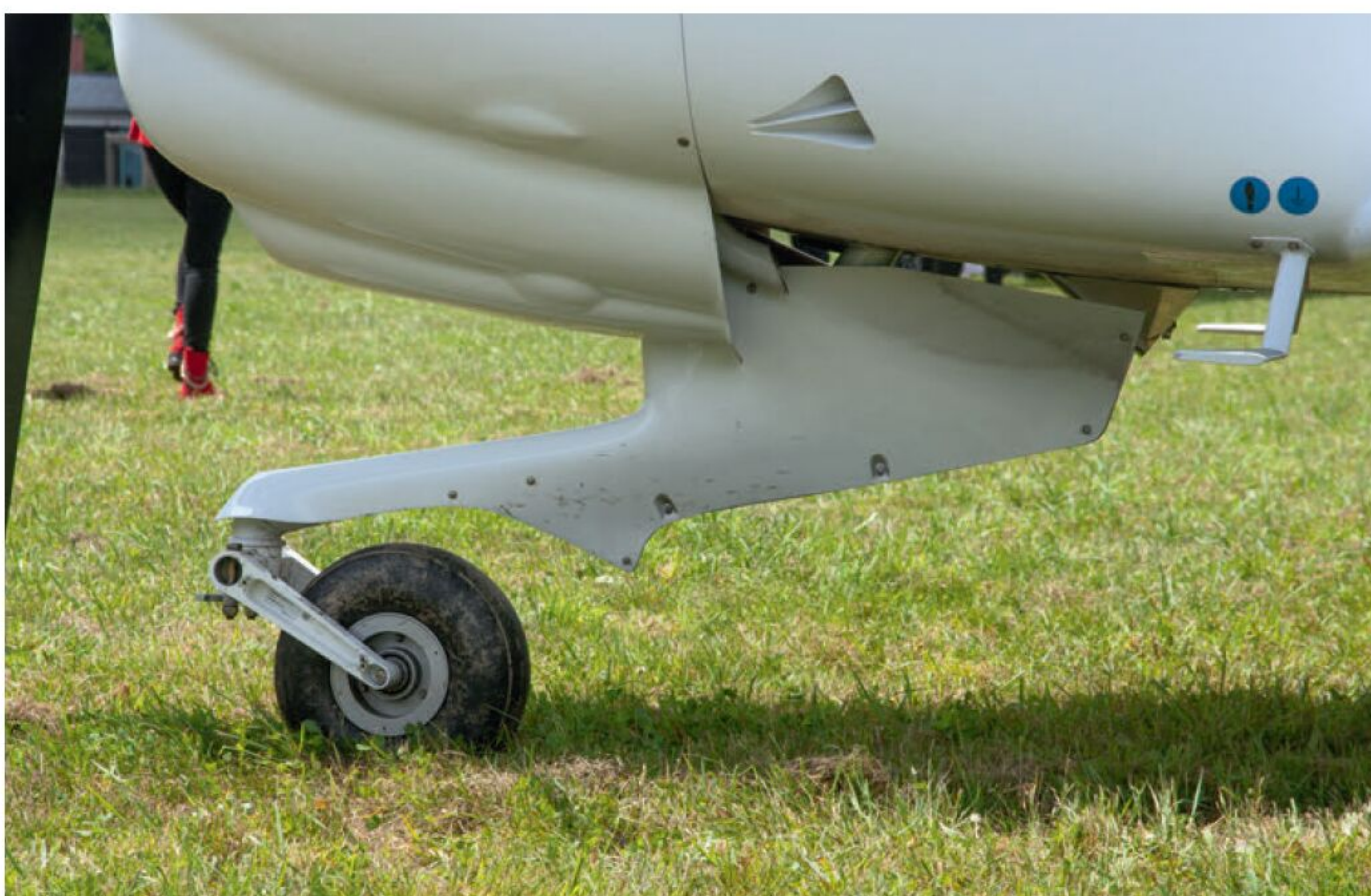
Die Bugfahrwerksverkleidung hat eine ziemlich komplexe Kontur.
