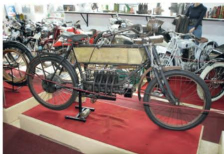
Eines der ersten Vierzylinder-Motorräder von FN aus 1904. 362 ccm, Antriebswelle auf das Hinterrad, keine Kupplung, kein Getriebe!
