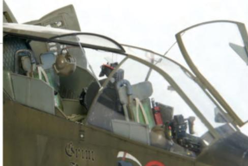
Man erkennt die seitliche Panzerung zum Schutz der Piloten.
