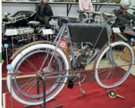
Das erste von FN gebaute Motorrad 1901. 133 ccm Viertakter, Riemenantrieb.
