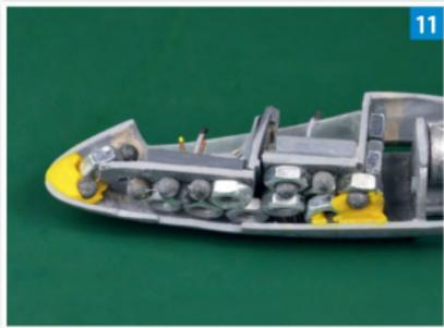
11 Volle Ladung Schrott für die nötige Balance. Hier worden Bleikugeln „bemuttert“.
