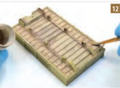
**12** Anschließend erfolgte die Verwitterung der Ladefläche. Die Trocknpigmente wurden direkt auf das Modell aufgetragen ...
