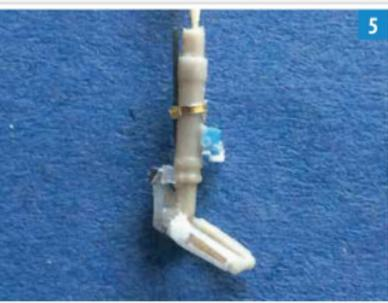
**5** Das überarbeitete und verbesserte Bugfahrwerksbein profitiert deutlich von den Selbstbauteilen.
