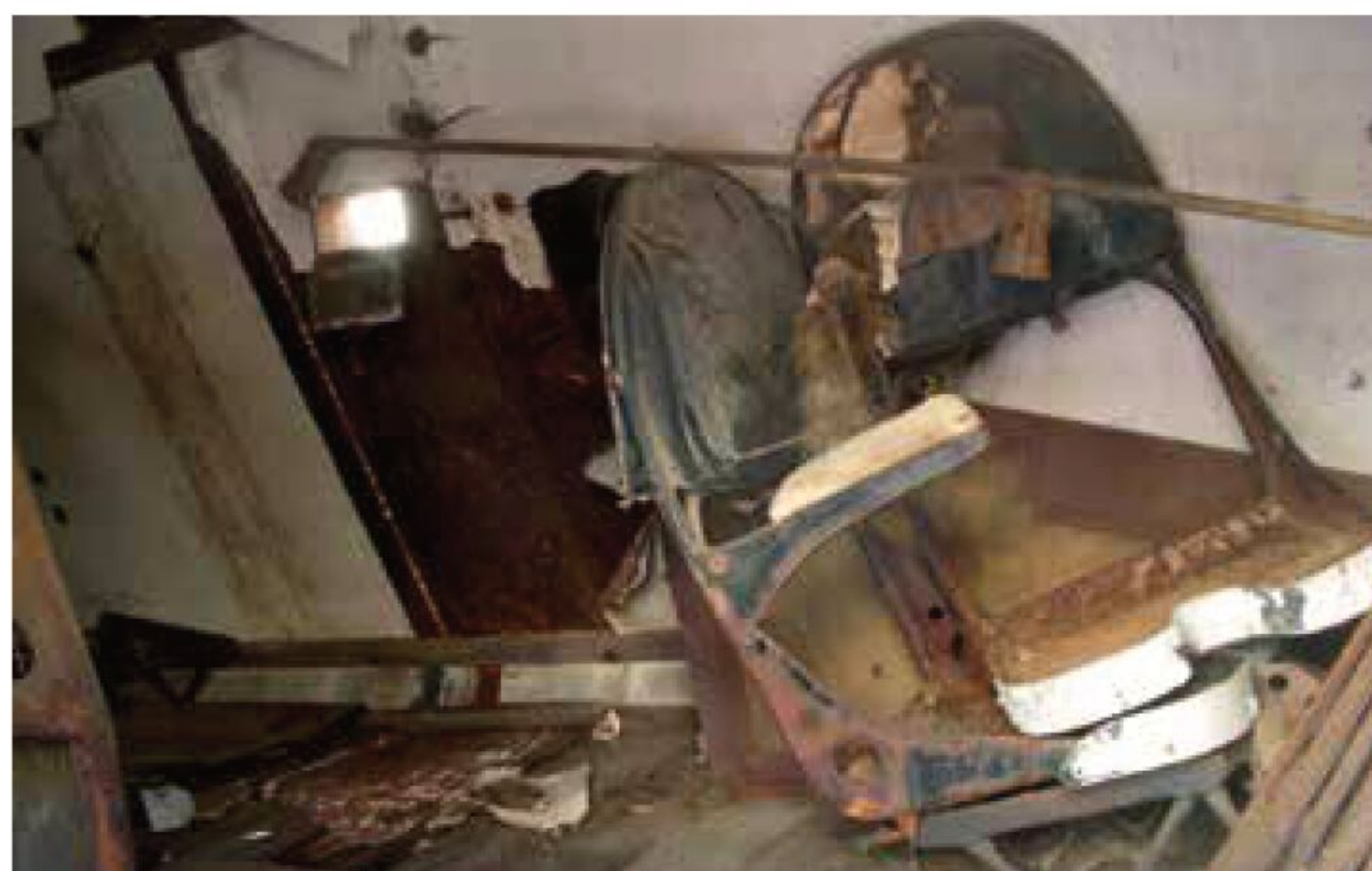
Der Innenraum ist in keinem guten Zustand mehr: im Boden klafft ein großes Loch.
