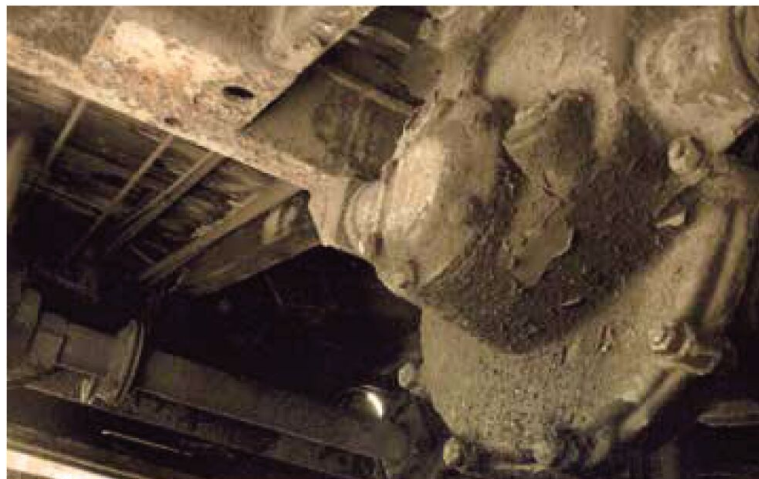
Der asymmetrische Kettenantrieb. Rechts oben: der Spurkranz vom Rad.
