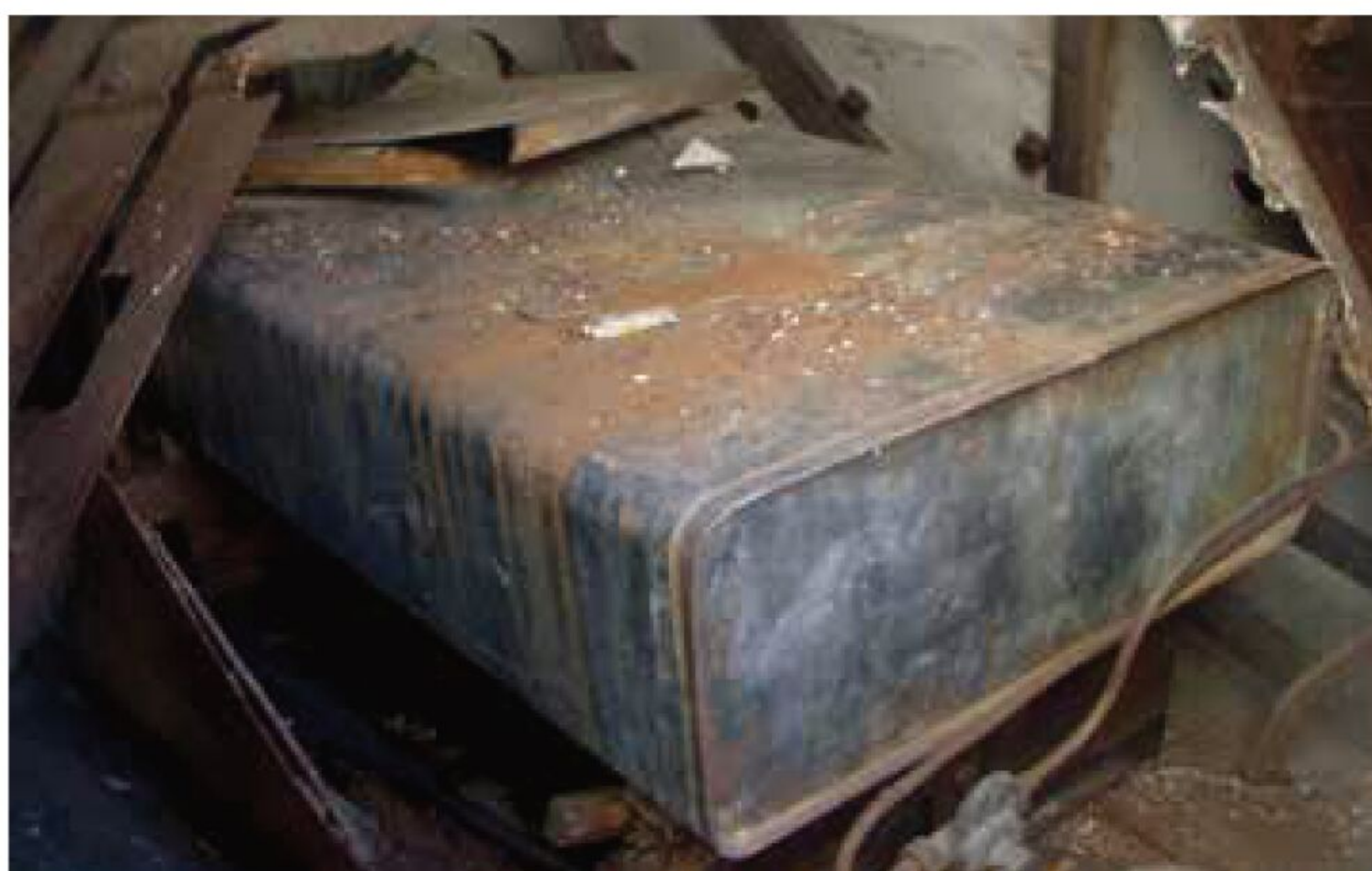
Der längs vor dem Motor liegende Tank ist noch gut erhalten geblieben.
