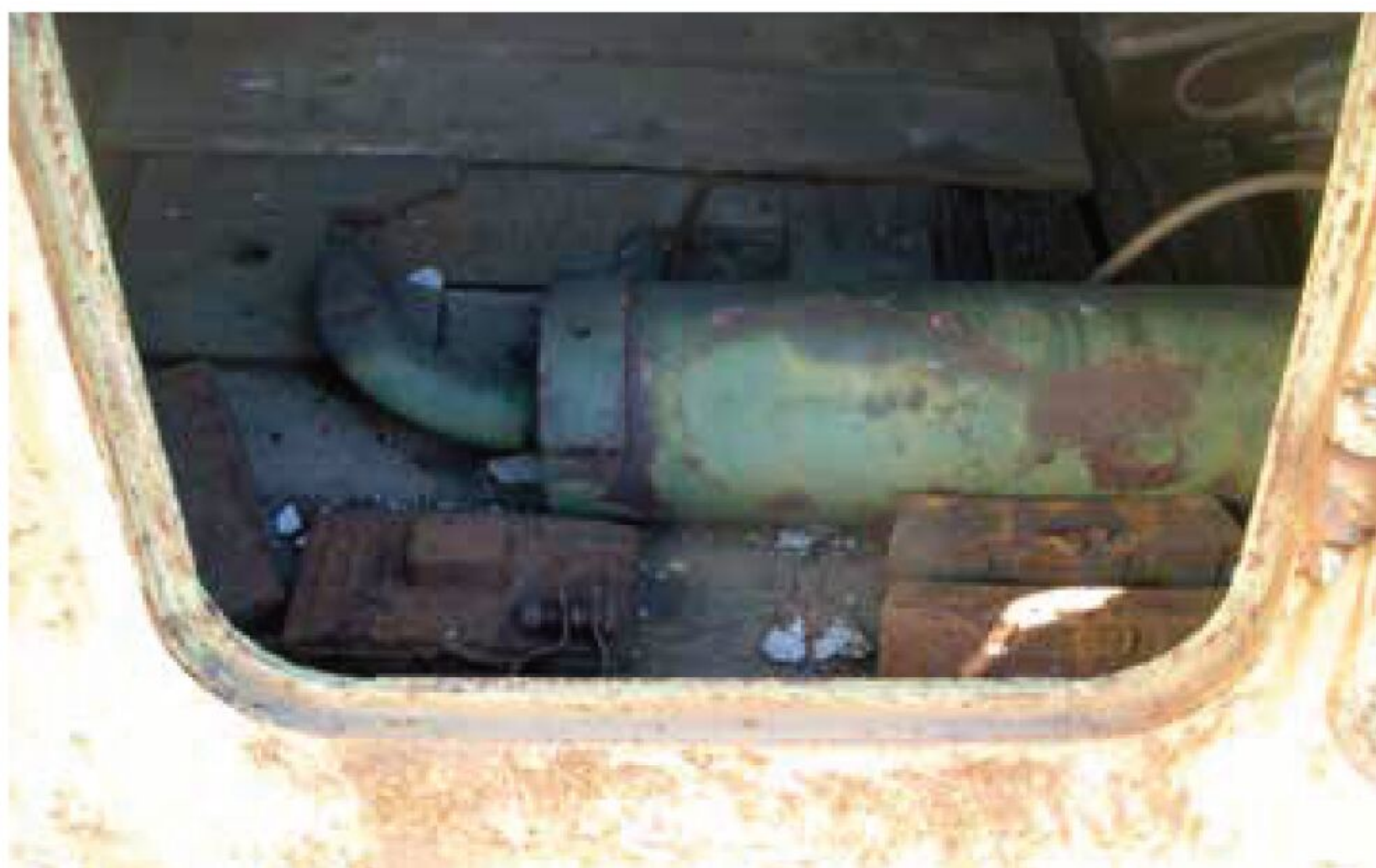
Innen abgelegt ist einer der beiden, sonst extern montierten, Auspufftöpfe.
