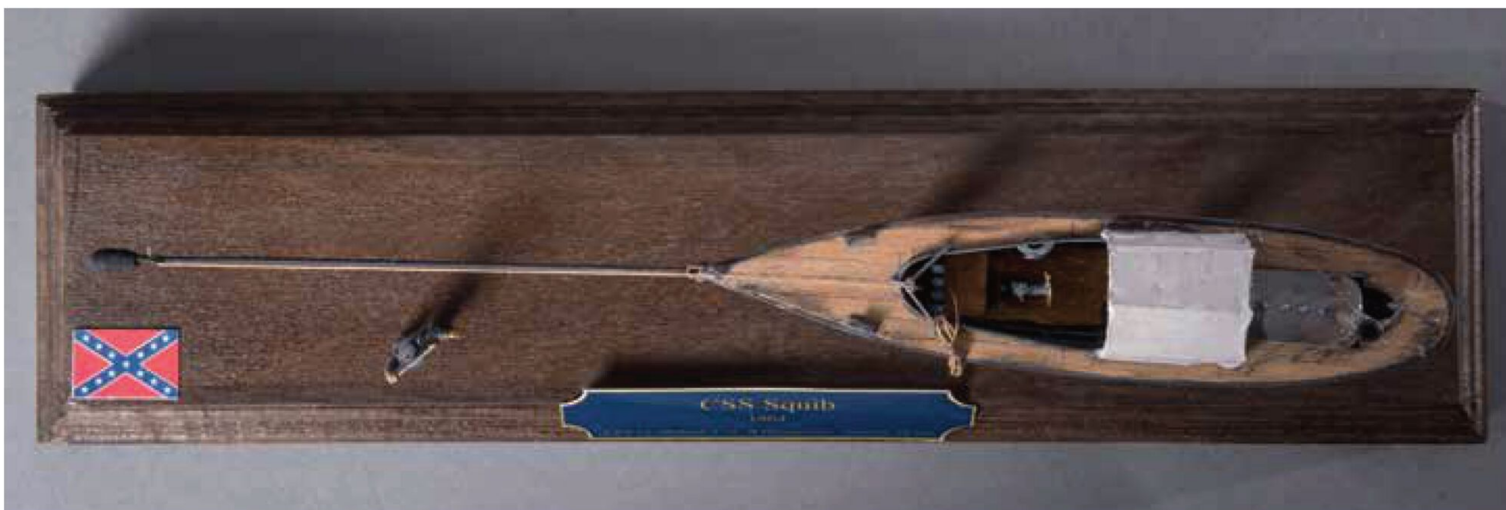
An der Spitze der Spiere ist der eigentliche „Torpedo“ befestigt.
