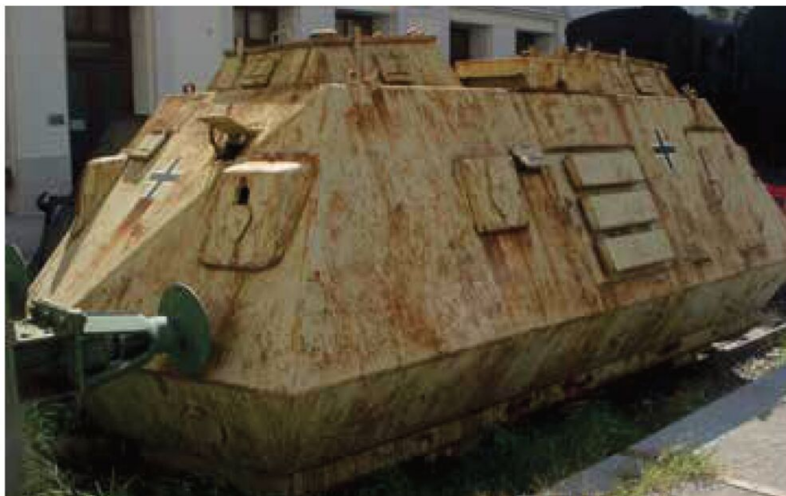
Interessant: frühe MG-Blenden, späte Art der Lüftungsabdeckung (eckig).
