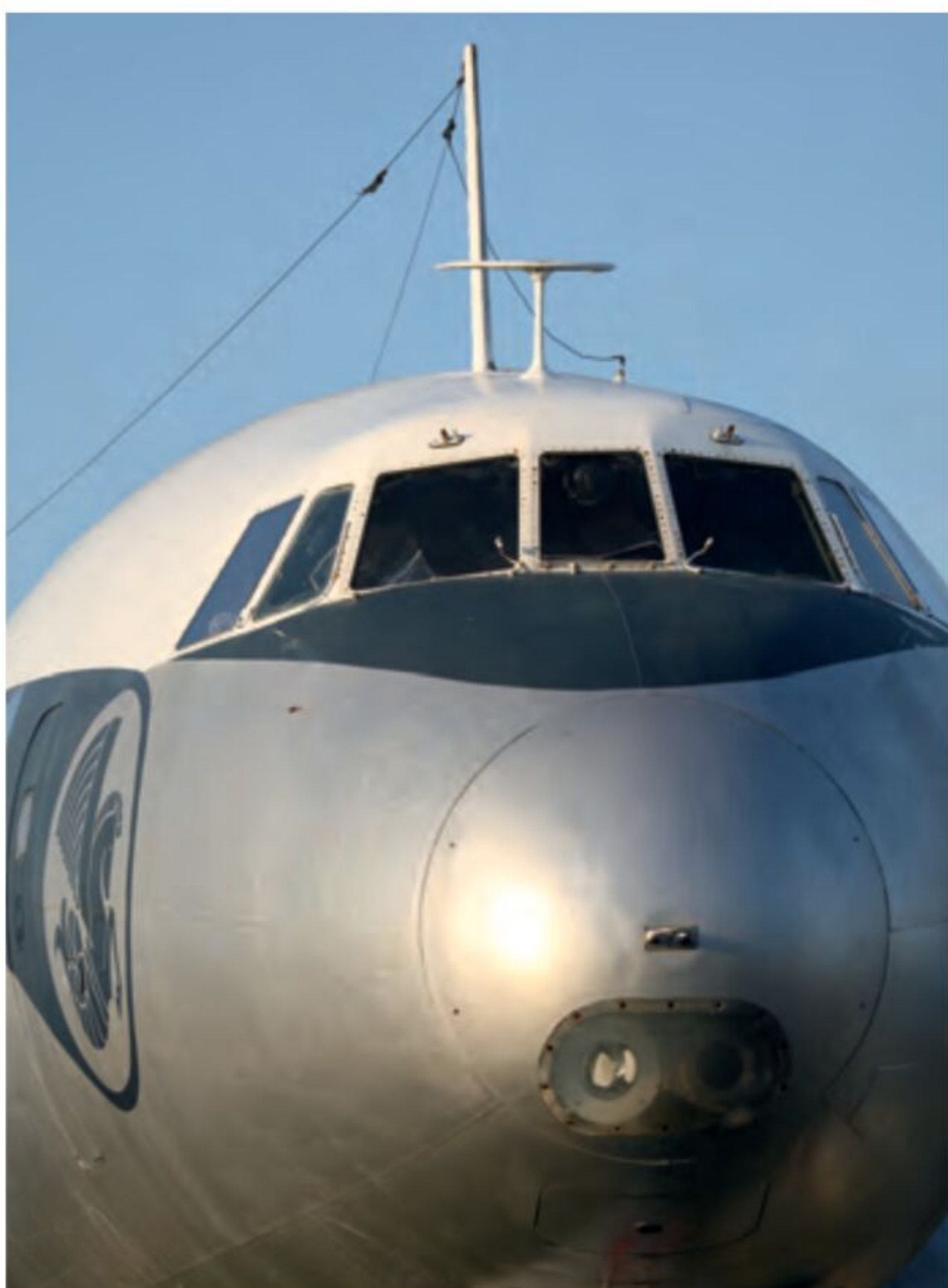
Die Nase einer Air France L1049, Ausführung mit Doppelscheinwerfer.
