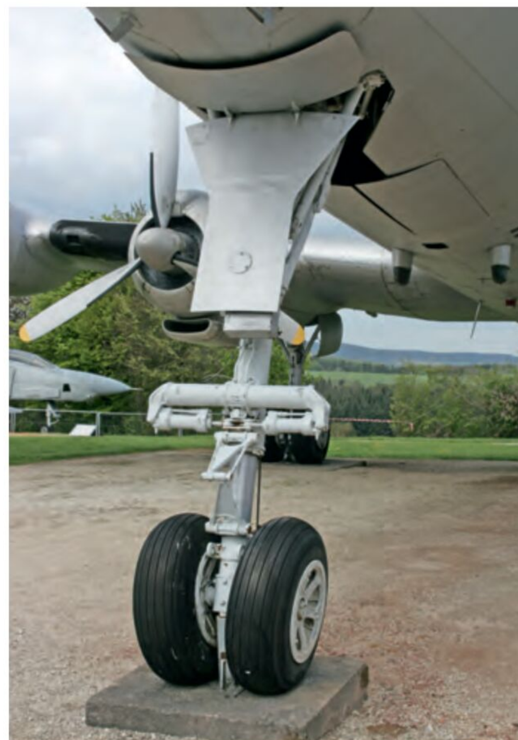
Das typisch hochbeinige Bugradfahrwerk im Detail.
