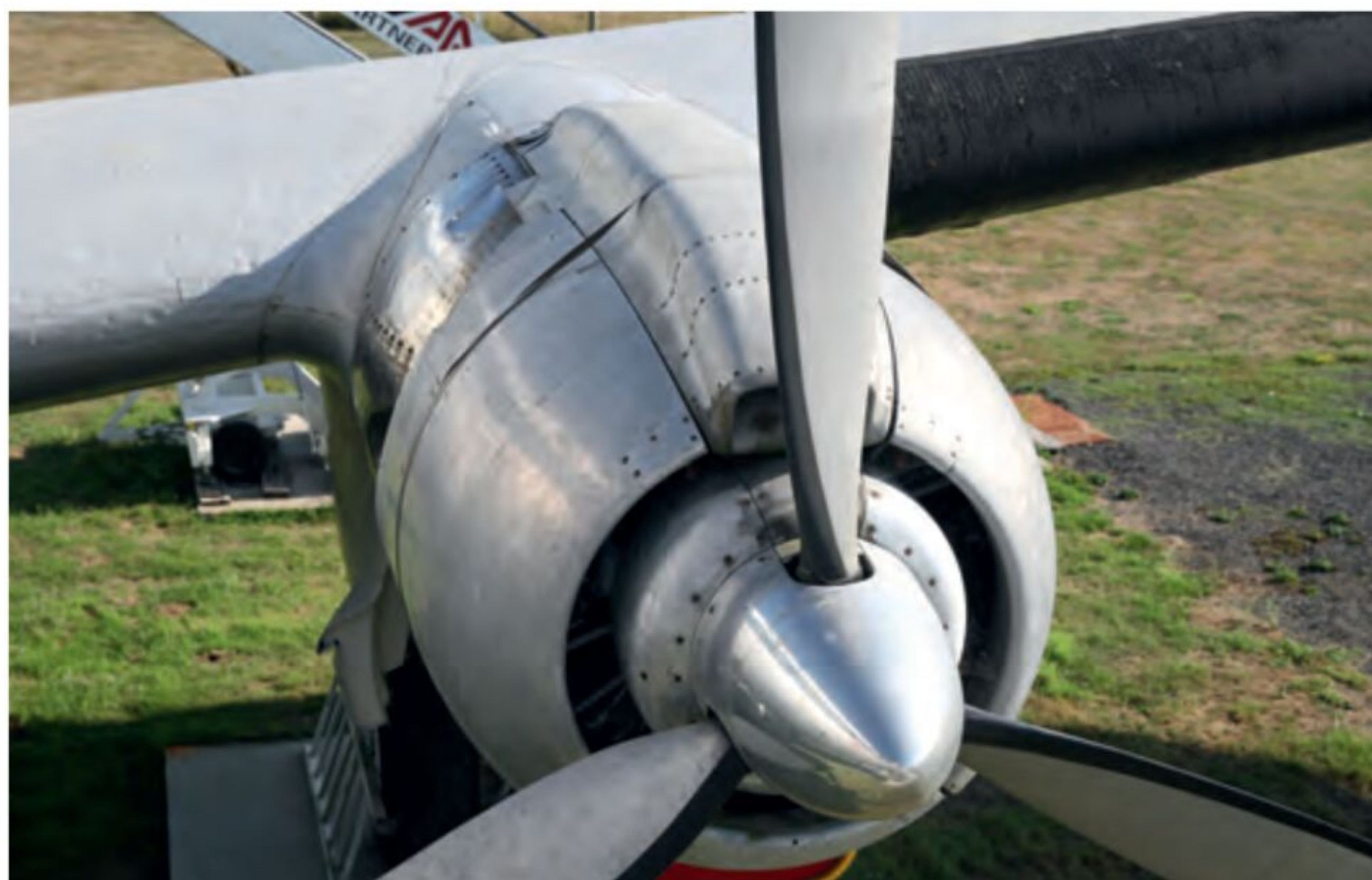
Typisch für die Turbo Compound-Motore der Super G Connie ist die aerodynamische Verkleidung hinter dem Spinner.
