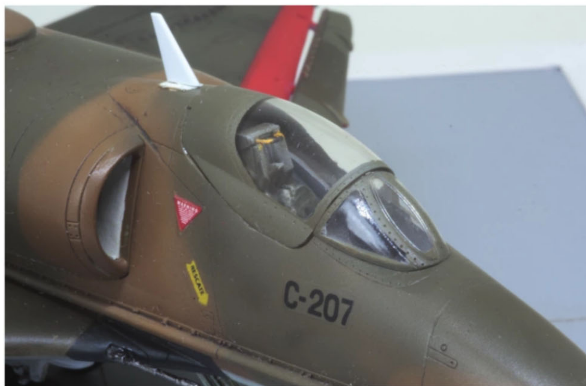
Hier ist die UHF-Antenne mit dem Sockel gut zu sehen.
