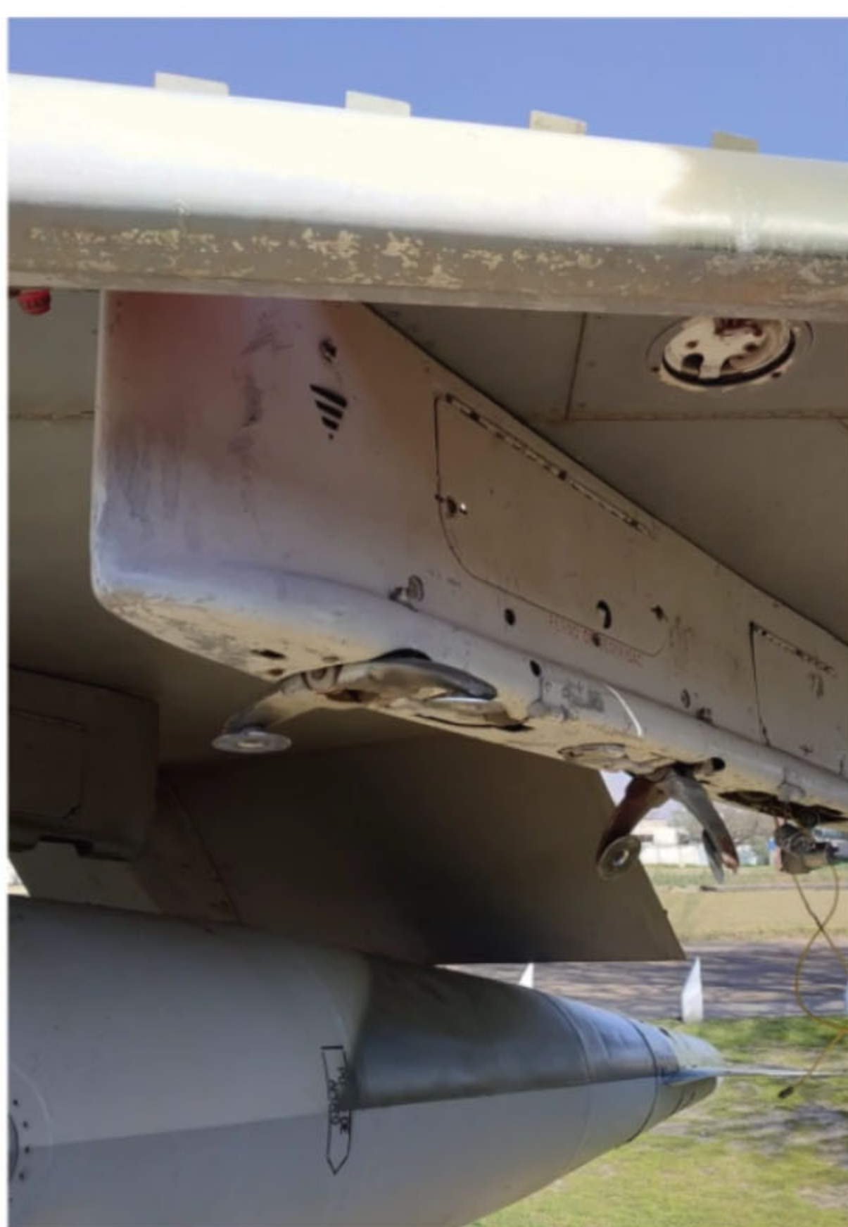
Die Details des Außenlastenträgers.
