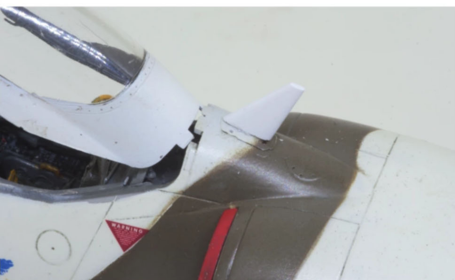
Die UHF-Antenne kommt aus dem Bausatz, den Sockel habe ich selbst angefertigt.
