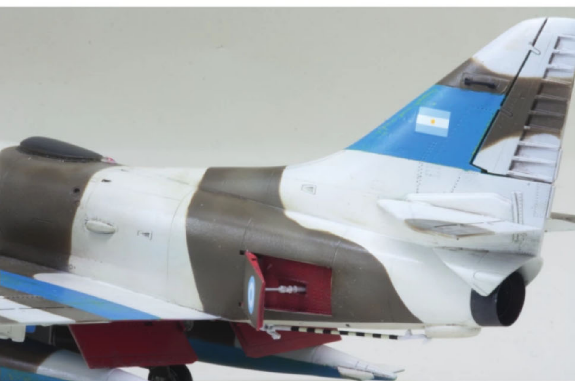
Der hintere Rumpfteil mit geöffneten Luftbremsen.
