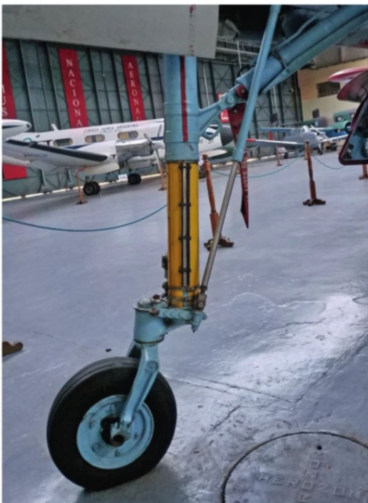
Das Bugfahrwerk der A-4C in einer ungewöhnlichen Stellung.
