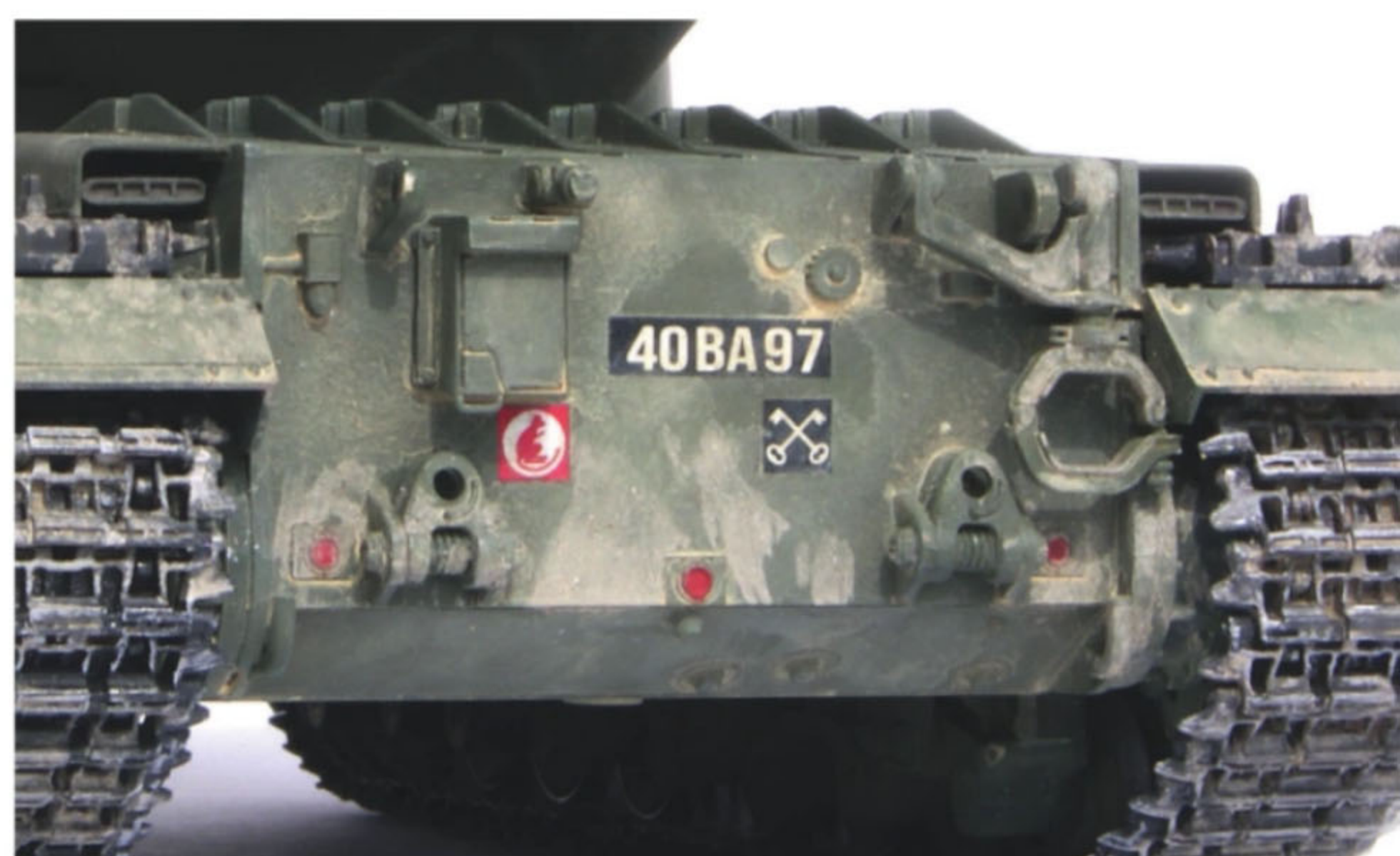
Rechts am Heck: die Rohrstütze für den Transport.
