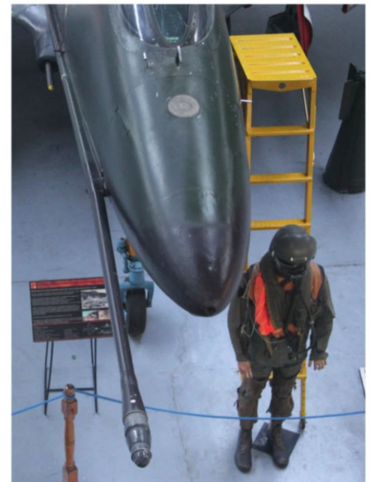
Die Nase der A-4B/P; gut sichtbar: die Sonde für die Luftbetankung.
