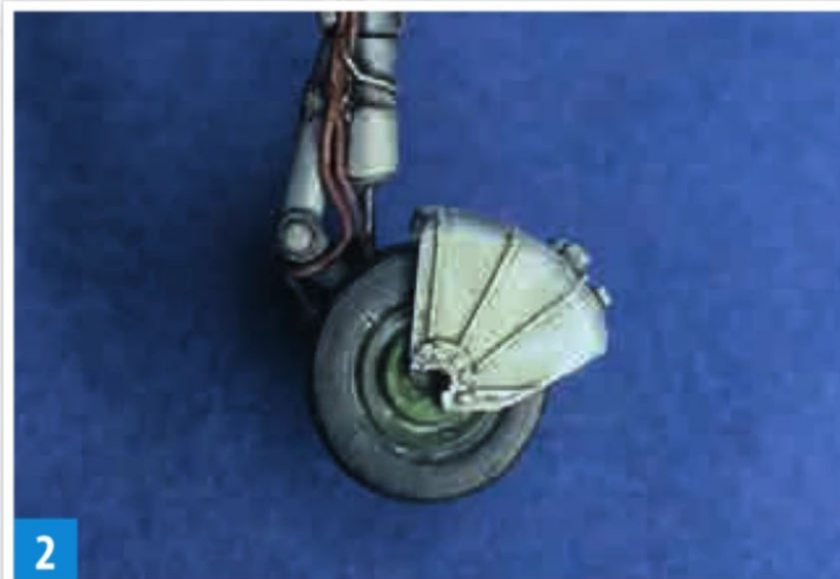
2 Der Schmutzfänger des Bugfahrwerks wurde neu aufgebaut.
