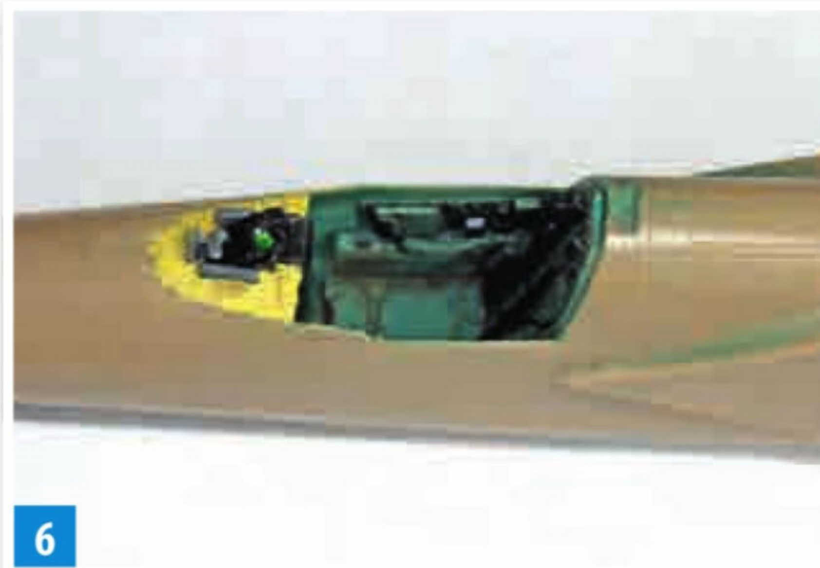
6 Das eingebaute Cockpit. Zu erkennen das schlecht passende Teil unter dem Windschutz. Die Übergänge wurden mit Milliput (gelb) aufgebaut.
