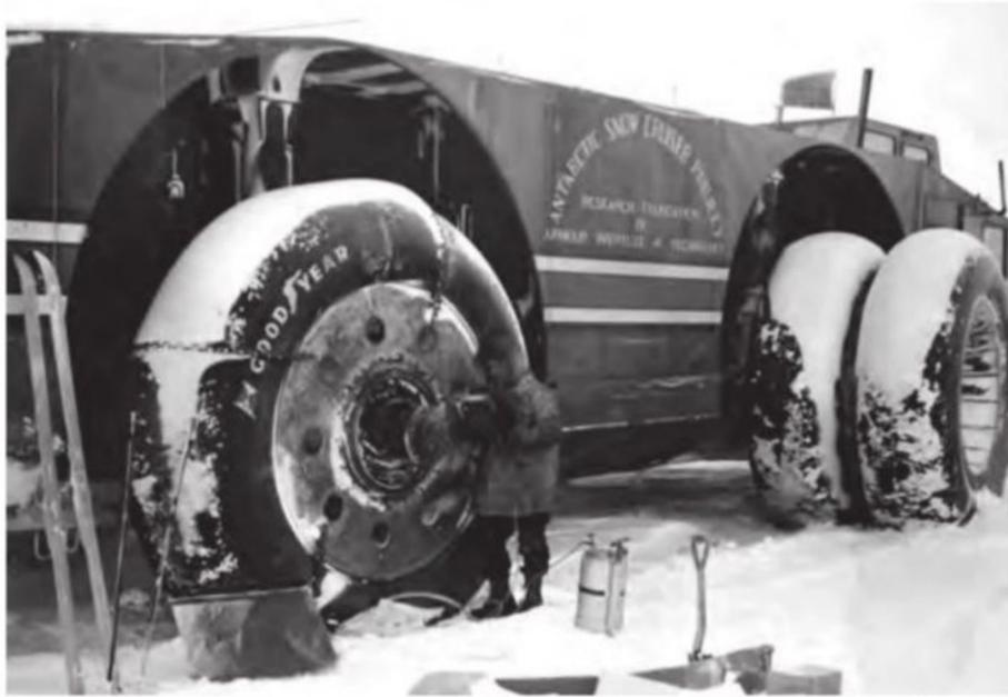
Die elektrischen Nabenmotoren machten die größten Probleme, da sie immer wieder einfroren. Hier erkennt man auch den Hubweg der Räder von über einem Meter!
