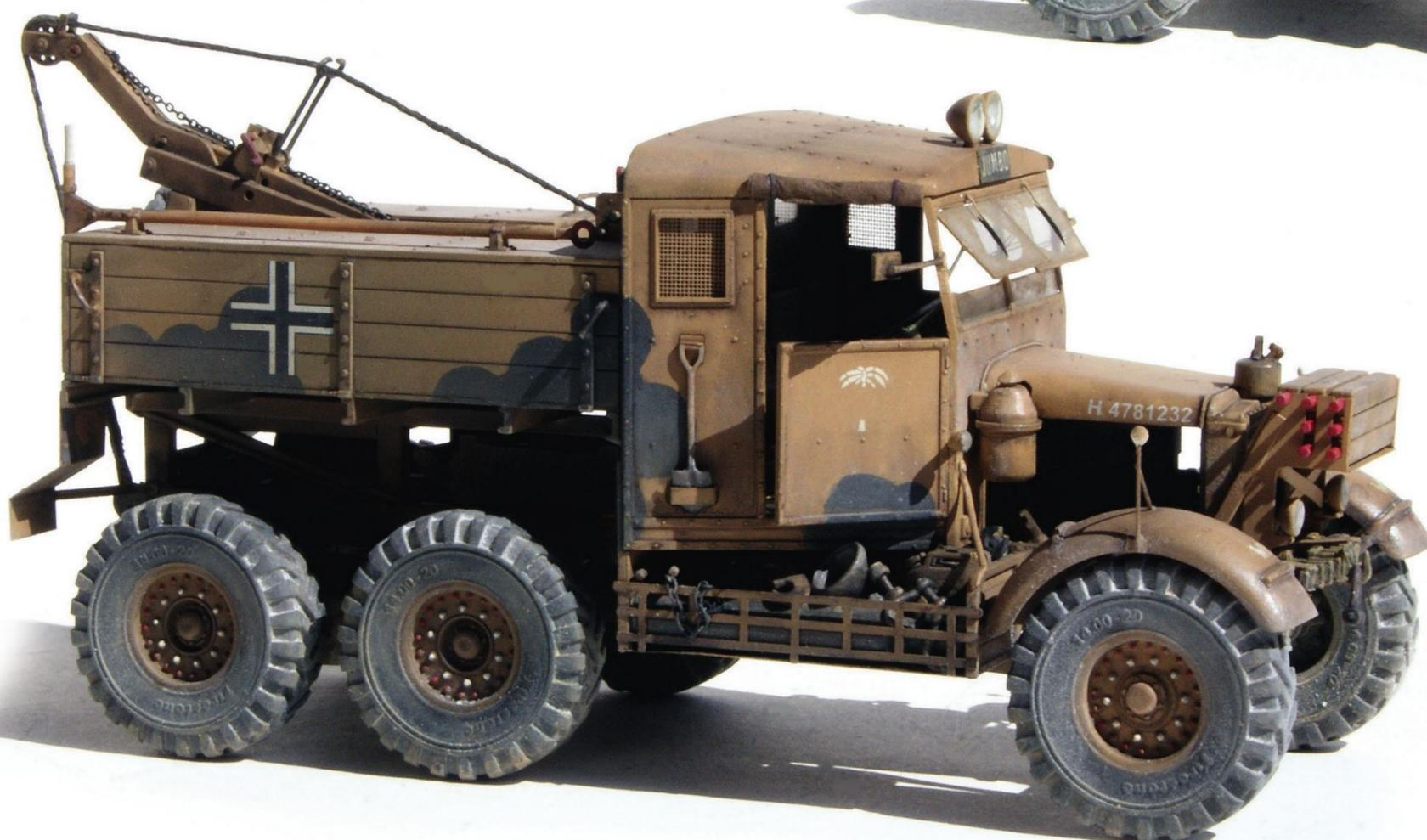
**Interessant an den Scammell Pioneer** ist nicht nur der 6x4-Antrieb an sich, sondern auch die Umsetzung an der Hinterachse. Es ist lediglich ein Differential vorhanden, das die Hinterräder über in einem Gehäuse untergebrachte Ketten antreibt. Der Scammell wurde regulär in den Armeen des Commonwealth, in der Sowjetunion, aber auch bei der Deutschen Wehrmacht als Beutefahrzeug genutzt.
