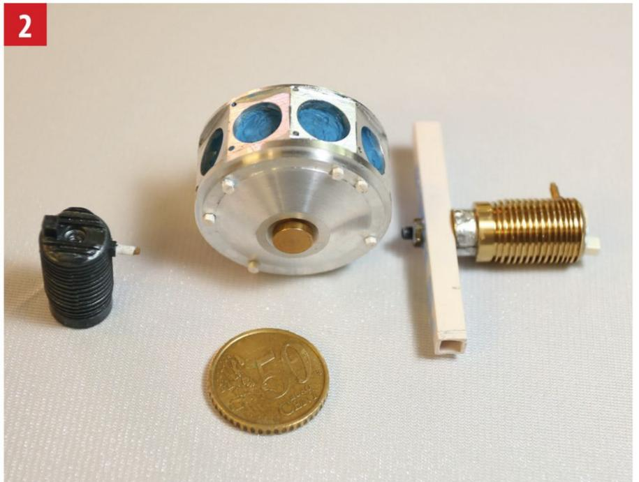
Das am Messingrohling angebrachte 6x6 mm ABS-Profil dient zur Fixierung während des Abformprozesses. Im Kurbelgehäuse wurden die Öffnungen für die Zylinder mit Knetmasse verschlossen. Links ein fertig bemalter Zylinder.
