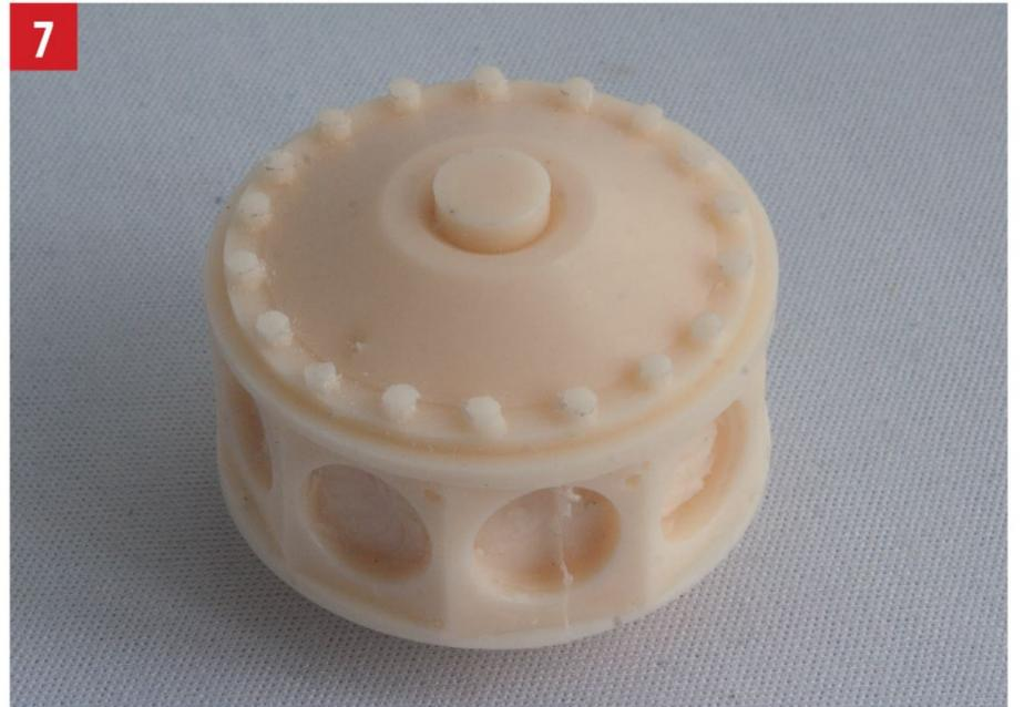
7 Das Kurbelgehäuse ist fertig gegossen, Grate müssen noch entfernt werden. In jedem Fall ist sichtbar, dass der engagierte Modellbauer mithilfe der Gießharztechnik auch recht komplexe Bauteile ohne großen Aufwand herstellen kann.
