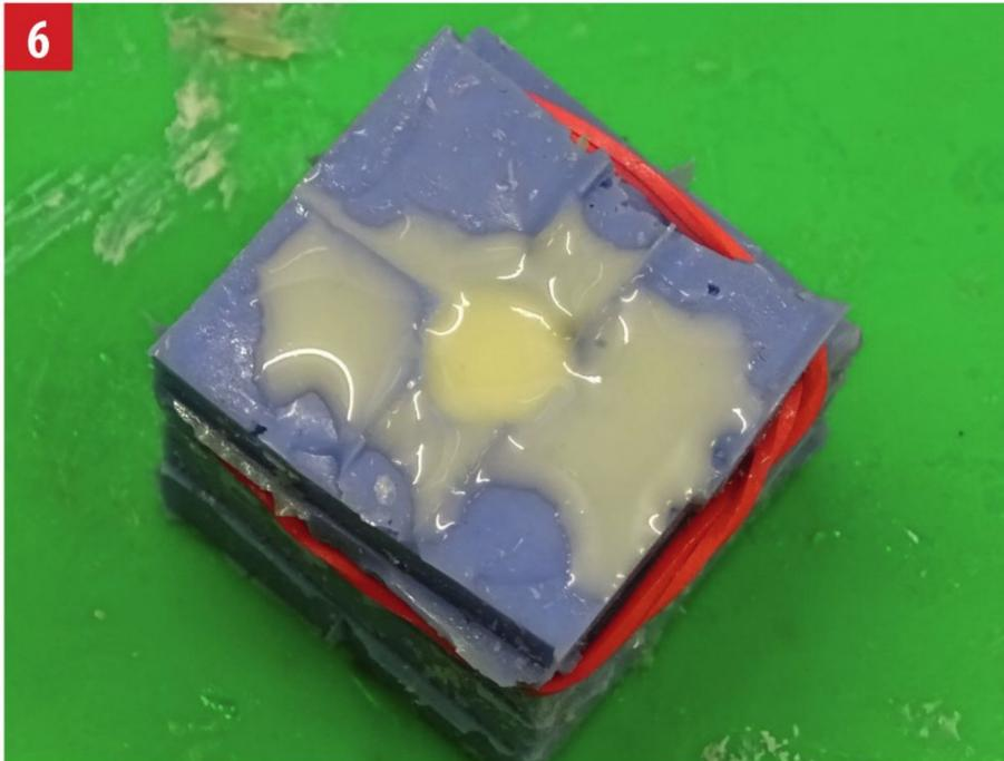
6 Nach ca. 1 Stunde ist das Harz ausgehärtet; je nach Fabrikat ändert sich die Farbe oder es wird trüb – bitte die Angaben des Herstellers genau befolgen!
