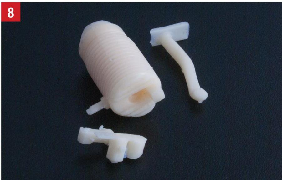
8 Jeder Zylinder besteht aus drei Gießharzteilen: dem Zylinder mit der angeformten Zündkerze, dem Ansaugrohr und der Kipphebelmechanik mit angeformtem Auslassventilgehäuse. Die Stößelstangen für die Ventilbetätigung wurden später aus Evergreen-Rundmaterial ergänzt.
