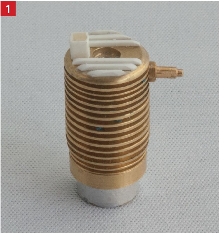
Der aus Messing gedrehte Rohling wurde mit Evergreen-Profilen vervollständigt und der Ansaugblock angebracht; nun ist er fertig zum Abformen.
