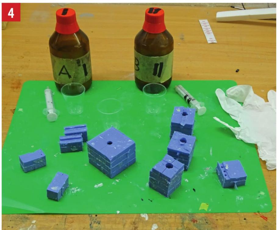
Wichtig ist, die Gefäße für die Gießharzkomponenten nicht zu verwechseln. Ich verwende Einwegplastikbecher aus dem Campingbereich, um das Harz anzumischen, und zum Dosieren Einwegspritzen (natürlich ohne Nadel). Damit lassen sich kleine Mengen der Komponenten genauer dosieren als mit einer Waage. Diese Spritzen verwende ich natürlich mehrmals! Dünne Latexhandschuhe sind dringend zu empfehlen!
