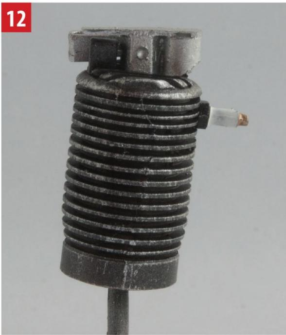
So sieht ein fertiger Zylinder mit Ventilbetätigung aus: Links der Ansaugteil, an den später die kupferfarbenen Ansaugrohre angeklebt werden, rechts das Gehäuse des Auslassventils – natürlich ohne Auspuffsammler oder Schalldämpfer – die Motoren waren höllisch laut!
