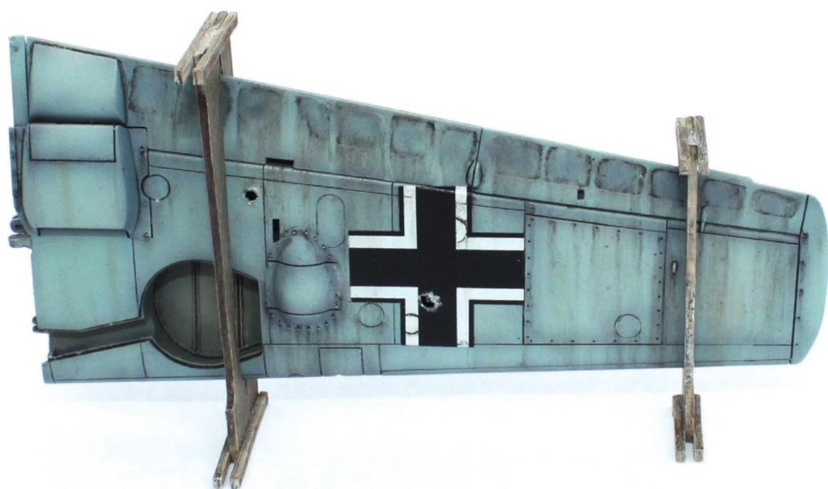
Ein fertig lackierter und gealterter Tragflügel im Transportgestell. Die Abmessungen der Transportgestelle sind in der Wartungsanleitung enthalten.
