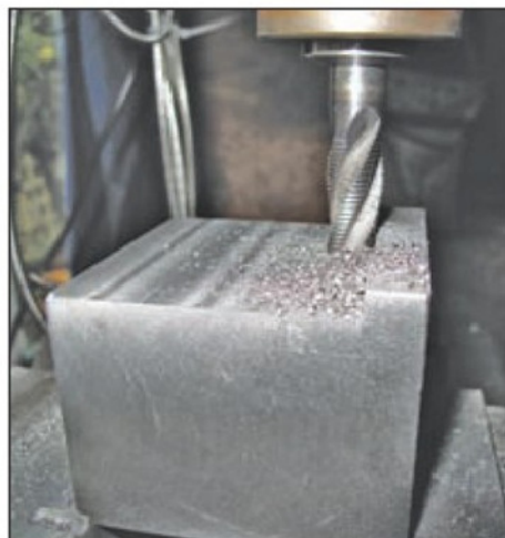
28. Roughing out the tenon.
