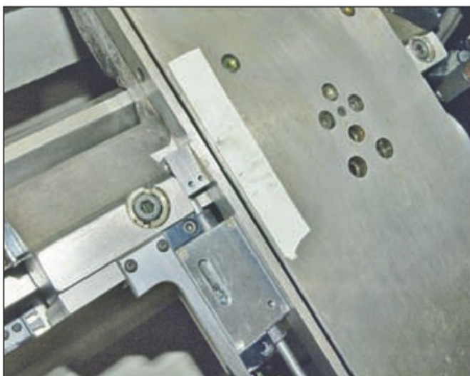
6. The X axis scale.
