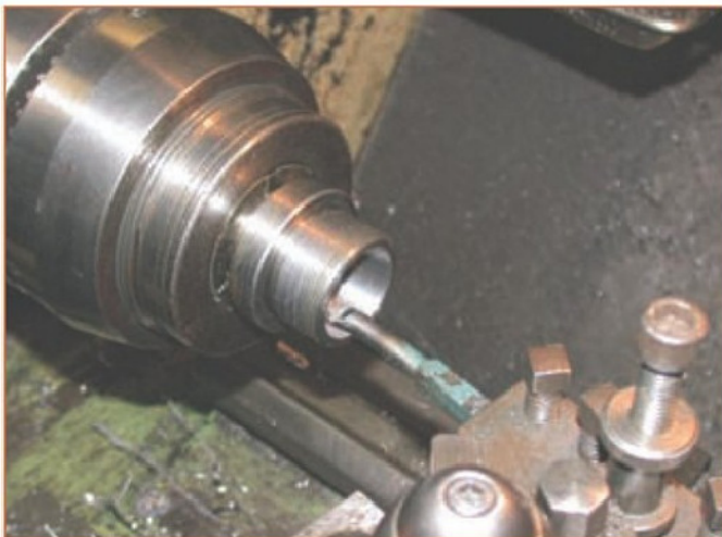
2. Finishing the ER taper
