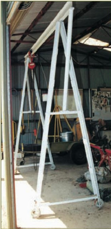
1. Gantry (portal) crane.
