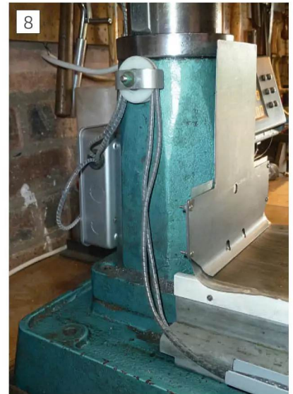
Y Axis Cable Guidance
