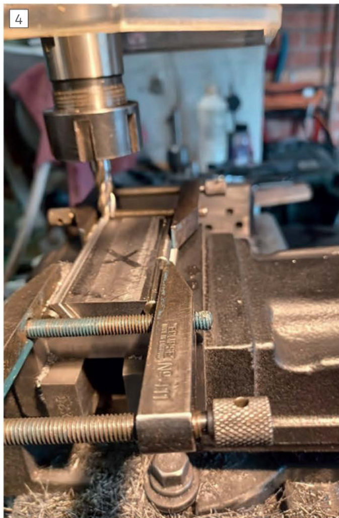
Machining gib in situ.
