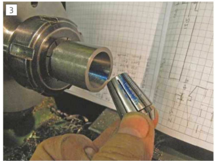
Checking the fit of the ER 20 collet
