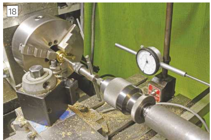
Tapping a hole for stud
