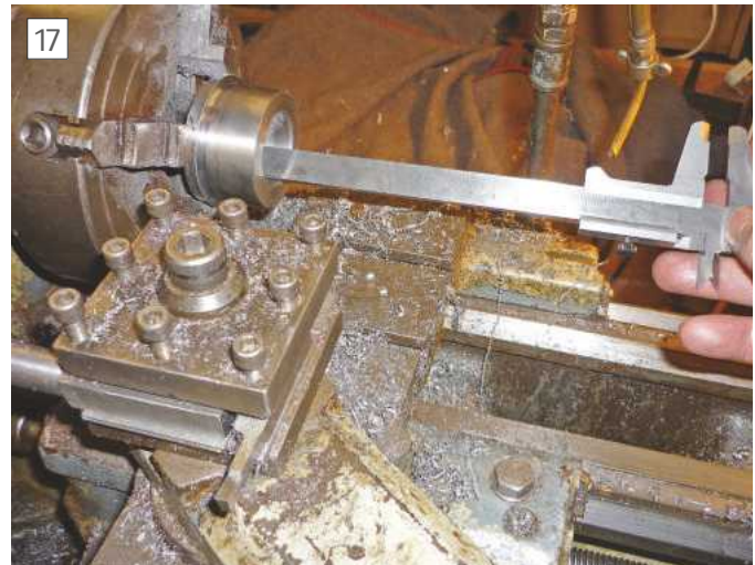
Checking Die Recess Depth
