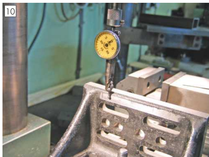
Alternative method using the DTI.
