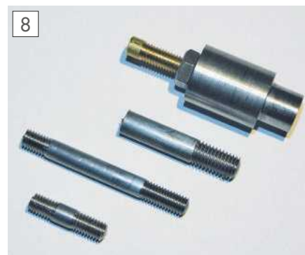
Studs and jig.
