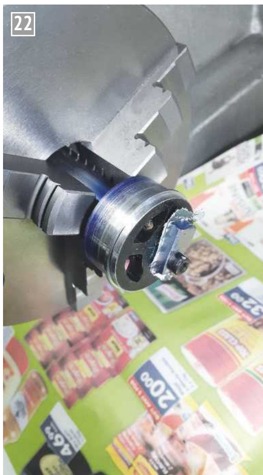
Eccentric machining jig.
