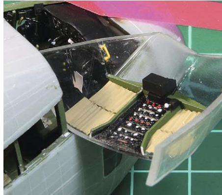
10 Sonnenschutz: Bleifolie schneiden, mit dem Fingernagel in eine Riffelung drücken, lackieren, ablängen – fertig!
