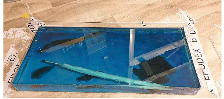
25 Blasenfrei: Eingelassene Acrylstäbe an den Rändern sollen im nächsten Schritt die bereits fertige Wasseroberfläche abstützen
