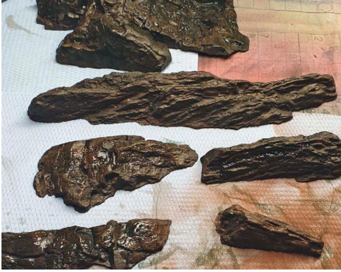
20 Ausgeformte und lackierte Felsen aus Gießgips: Wichtig für den Farberhalt im Zusammenhang mit Harz ist Klarlack
