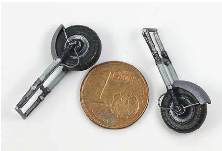
28 Die einbaufertigen Fahrwerke. Die blanken Teile der Dämpfer sind mit Manschetten verkleidet
