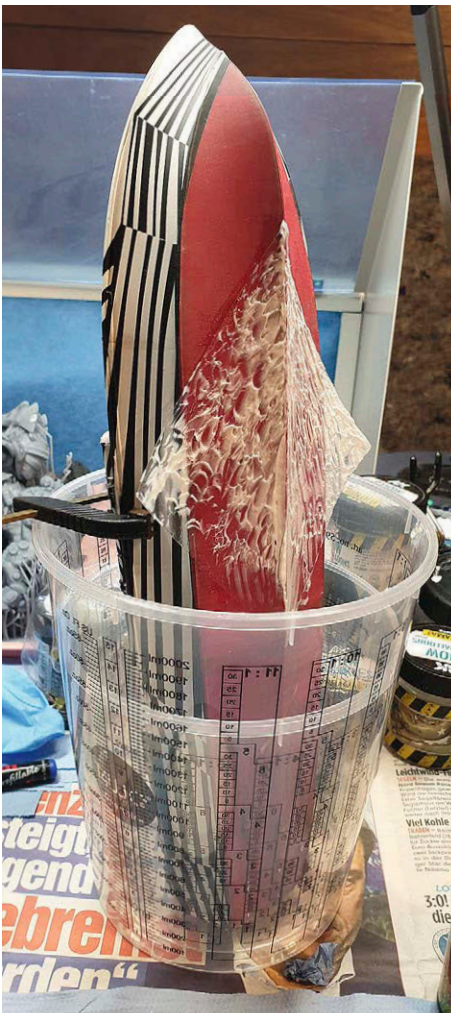
28 Völlig im Eimer: Adäquate Trockenstellung für die am Rumpf befestigte Laminierfolie, die bereits mit Strukturgel betupft wurde
