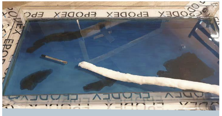
23 Liegeprobe vom Torpedo und der mit Klarlack benebelten Watterolle, die die Blasenbahn des Torpedos darstellen soll
