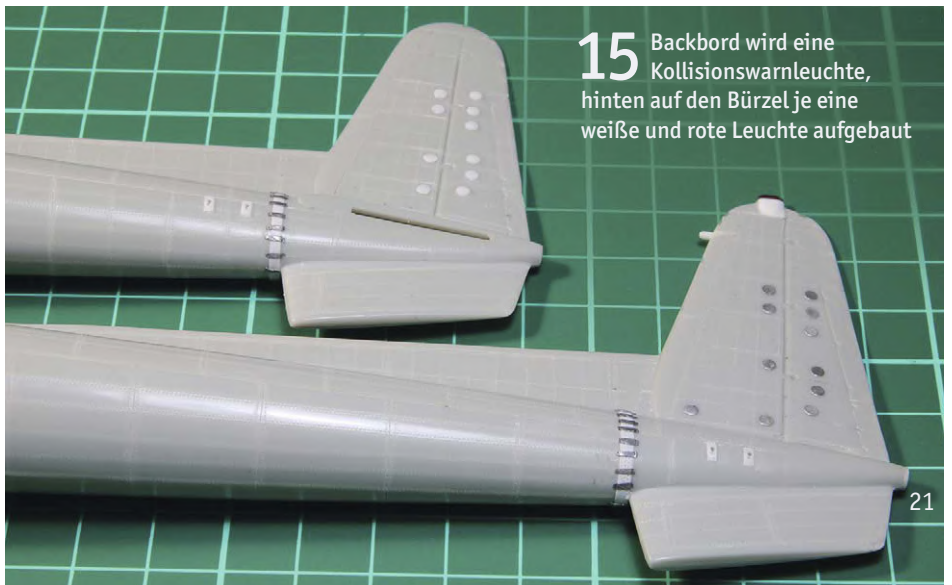
13 Am Leitwerk fallen die aufgesetzten Inspektionsdeckel auf, aus dünnem Joghurt-Becher gestanzt mit zwei Millimetern Durchmesser
