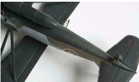
13 Die Unterseite ist in Schwarz MRP-255 lackiert. Der Tank ist zuallerletzt montiert
