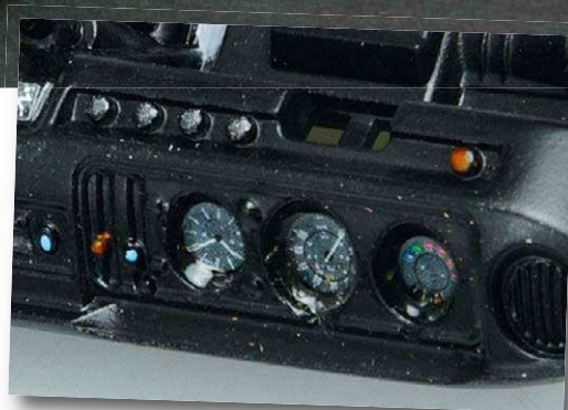
8 Mit klarem Resin wurde noch die Glasabdeckung des Tachos nachgebildet. Kleine Details wie Knöpfe sind bemalt
