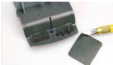
6 Ein Fahrradschlauch-Flicken wird zurechtgeschnitten und zu einer Fußmatte umfunktioniert
