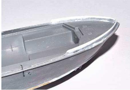
**5** Auch die Spritzleiste am Bug ist nicht genau genug und wird erhöht. Fehlende Ösen sind nun gebohrt
