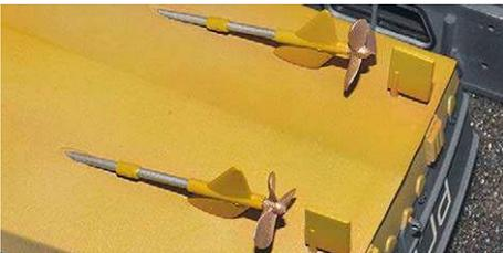
**18** Die nicht so guten gegenläufigen Propeller vom Kit sind aufwendig nachgefräst und geschliffen
