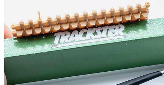
**4** Nach weniger als einer Minute sind alle 15 Stifte eingesetzt. Das Fixieren mit Klebstoff ist nicht zwingend notwendig, da die Pins einrasten, wenn man auf die Köpfe leichten Druck ausübt
