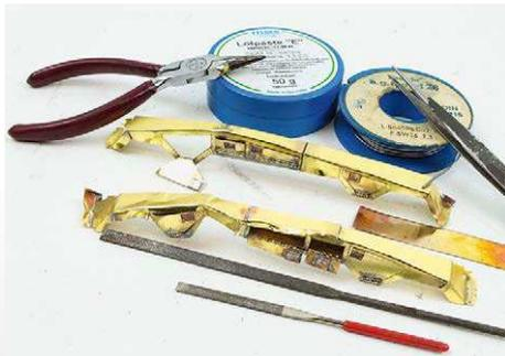
**5** Die charakteristischen seitlichen Staukästen wurden vom Autor komplett mit Ätzteilen aufgebaut, verlötet und realistisch beschädigt
