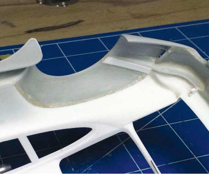
**1** Mittels angepasstem Sheet hat der Autor die inneren Klebestellen verstärkt und somit eine feste Verbindung garantiert
