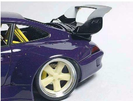
**9** Die kleinste Ausbaustufe der recherchierten Spoilertürme zum Vergleich. Dieser Testfit dient nur als Probe. Später wird das gedruckte Teil verbaut
