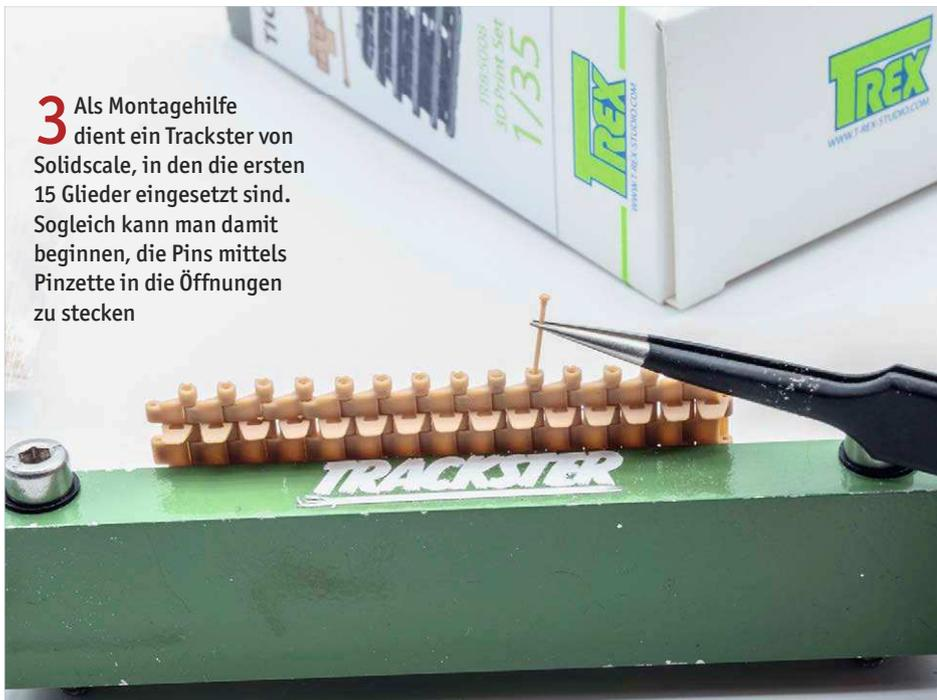
**3** Als Montagehilfe dient ein Trackster von Solidscale, in den die ersten 15 Glieder eingesetzt sind. Sogleich kann man damit beginnen, die Pins mittels Pinzette in die Öffnungen zu stecken
