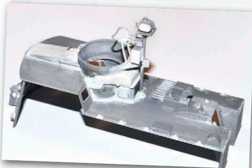
**9** Links und rechts die Luftschächte, die vom Verdampfer von hinten nach vorne in das Dach führen
