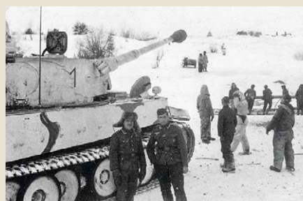
Der Tiger mit der Nummer 1 ist ein späteres Baulos, wie die große Luke an der rechten Turmseite zeigt. Er gehört allerdings ebenfalls zur schweren Panzerabteilung 502
