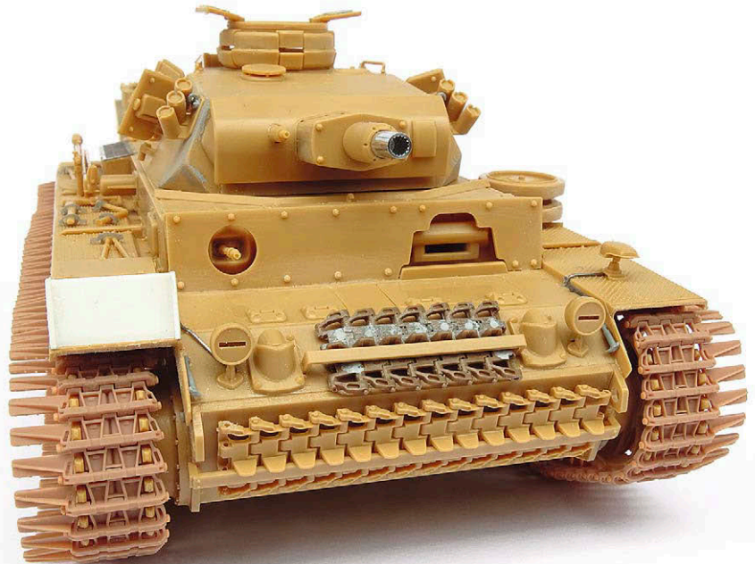
17 Ersatzketten am Bug zeigen normale Kettenglieder und die vorderen Ketten-Abdeckbleche fehlen oder sind hochgeklappt
