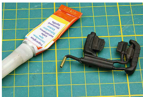
4 Die Abgasanlage ist unzureichend. Der Auspuff ist durch ein Messingrohr ersetzt und mit Sekundenkleber befestigt
