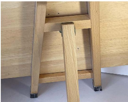
Damit der Stellwinkel steiler wird, hat der Buchständer ein Mini-Staffelei als Stütze erhalten. Gummierung an den Füßen verhindert Wegrutschen
