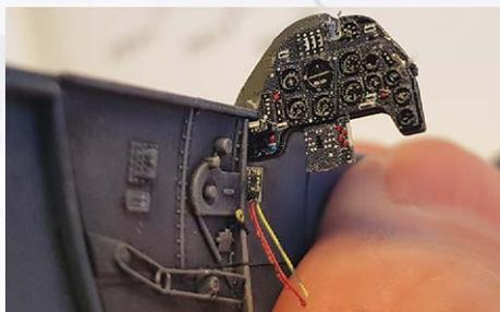
**2** Das Instrumentenbrett der G-10 besteht aus mehreren Schichten, die man dann übereinander anbringt
