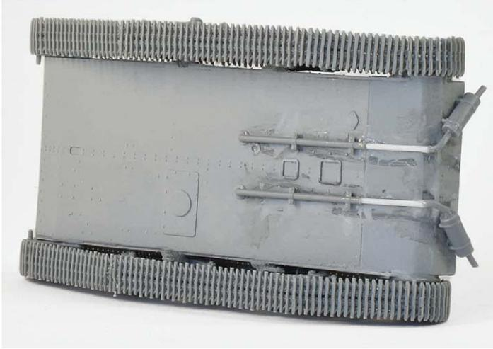
**8** Das Laufwerk, mit Ketten komplettiert. Schräg gesetzte Auspufftöpfe. Nun ist der Ladungsleger nahezu fertig
