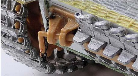
**4** Mit 0,5-mm-Bohrer ein Loch durch den Haltebolzen bohren, aus Kupferdraht eine Öse biegen und alles mit dem Kettchen verbinden
