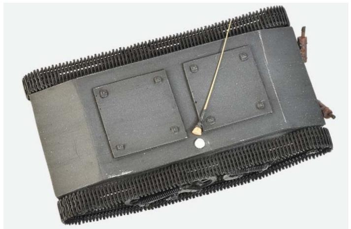
**11** Eine kleine Unachtsamkeit und die Antenne bricht mitsamt dem Antennenfuß ab. Nachkonstruieren ist jetzt gefordert
