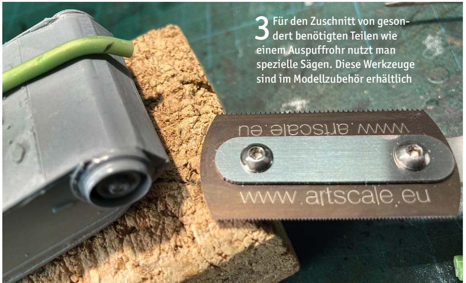
**3** Für den Zuschnitt von gesondert benötigten Teilen wie einem Auspuffrohr nutzt man spezielle Sägen. Diese Werkzeuge sind im Modellzubehör erhältlich
