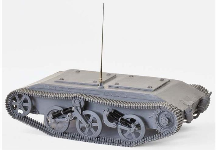
**9** Den leichten Durchhang der Ketten lassen die aus Einzelgliedern und Segmenten bestehenden Bauteile problemfrei zu
