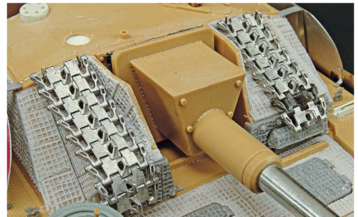
12 Fotos zeigen: Ersatzkettenglieder, auf den Schrägen des Kampfraumes angebracht, sollten den Panzerschutz erhöhen
