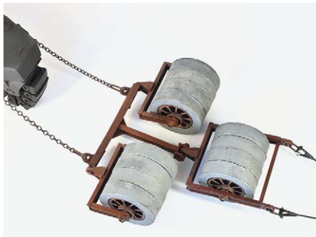
Das Minenräumgeschirr ist am Zugfahrzeug per Ketten und Stahlseilen an das nachlaufende Nebenfahrzeug eingehängt
