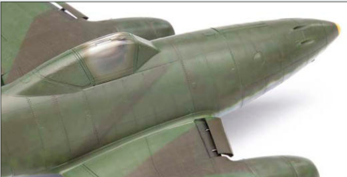
11 Kleinere Spalten an den Verbindungsstellen lassen sich mit Acrylpachtel und Wattestäbchen schnell schließen
