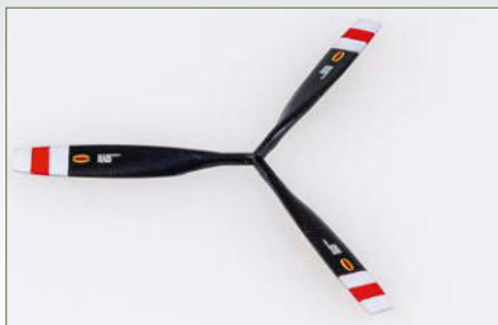
18 Lackierte Warnstreifen wirken deutlich überzeugender als Decals. Mit den letzten Markierungen sind die Propeller komplett und warten auf den Einbau
