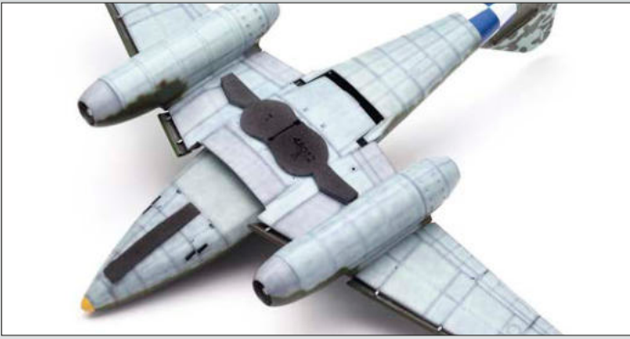
9 Das Zusammenführen von Flügeln und Rumpf geschieht in mehreren Schritten. Zuerst kommt der hintere Bereich
