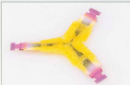
17 Die Spitzen erhielten einen weißen Anstrich. Selbst geplottete Masken legten die roten Streifen fest. Eine pinke Vorgrundierung sorgt für kräftiges Rot
