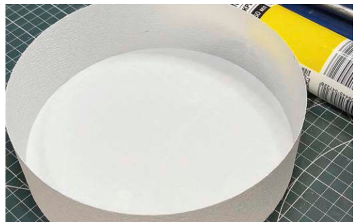
16 Die Basis entstand zunächst als 3D-Modell und kam danach aus dem Drucker, was eine präzise und gut planbare Grundlage schafft
