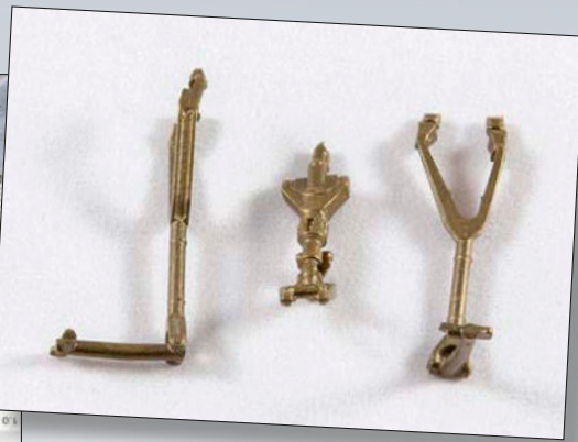
8 Das filigrane Fahrwerk gibt unter dem Modellgewicht nach. Ein Metallfahrwerk von AeroCraft schafft hier Abhilfe
