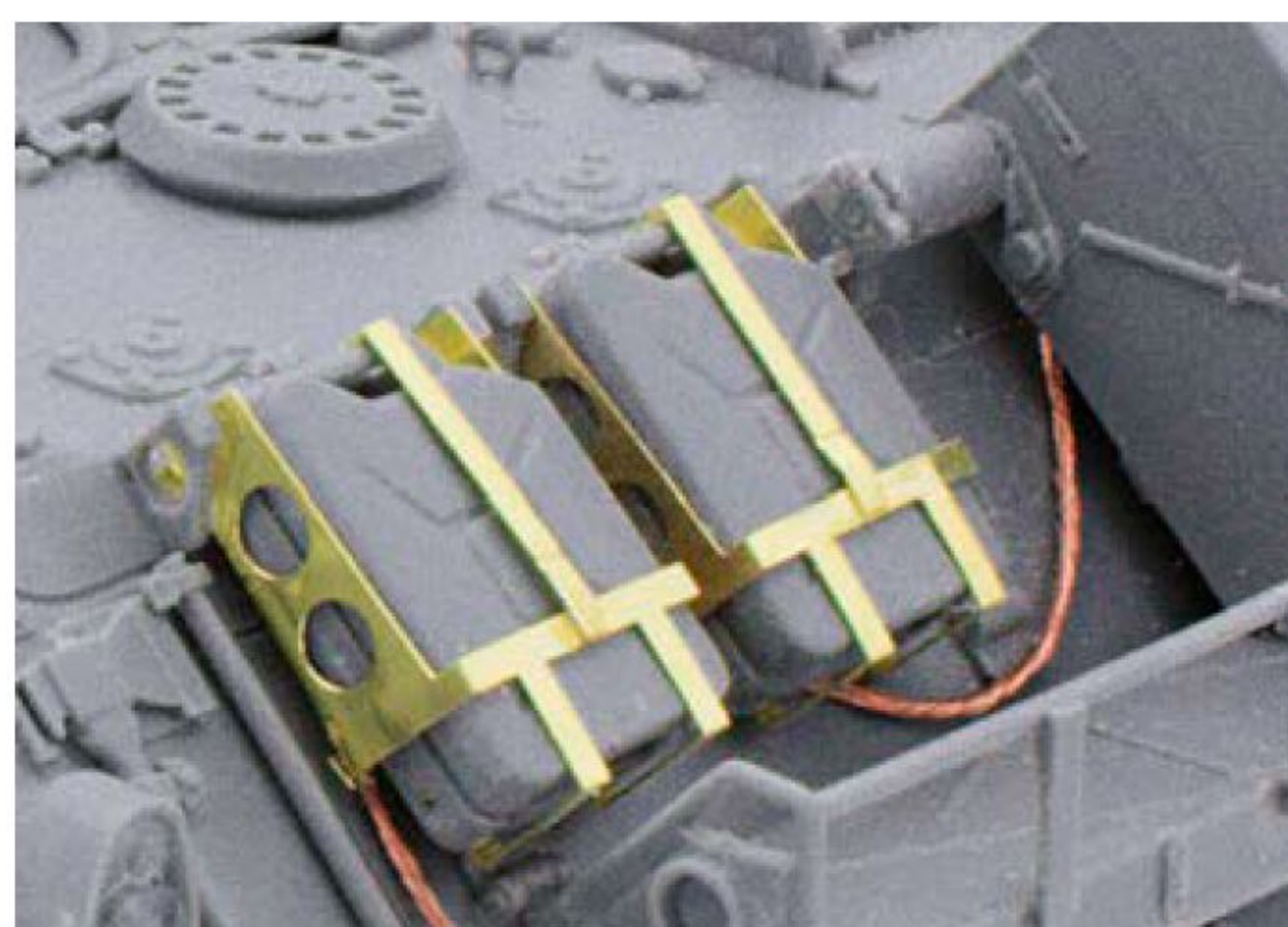
10 Das Biegen der Kanisterhalterungen verlangt etwas Geduld. Die oberen Konsolen sollten vor dem Verkleben zur Probe angepasst werden
