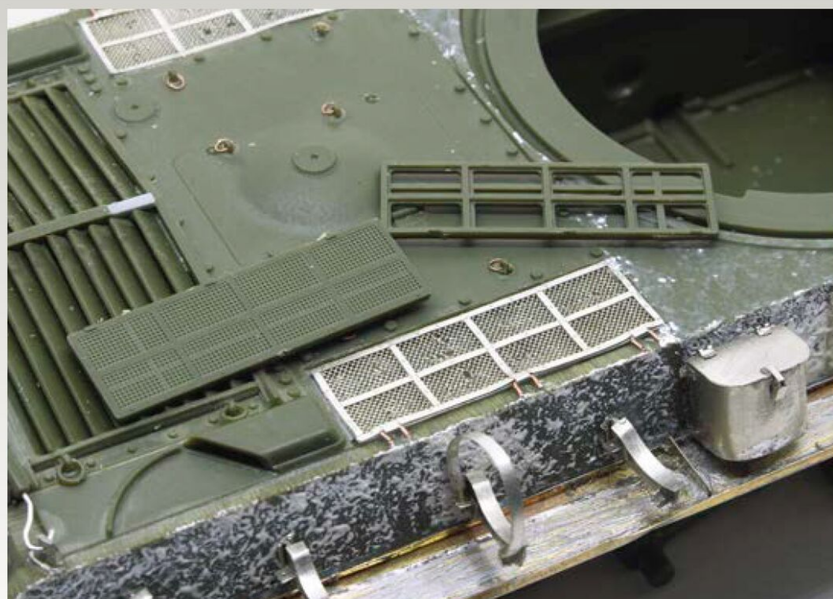
3 Die Kunststoff-Motorgitter des Bausatzes überzeugen nicht. Ohne geätzte Ersatzgitter lässt sich das Erscheinungsbild kaum verbessern
