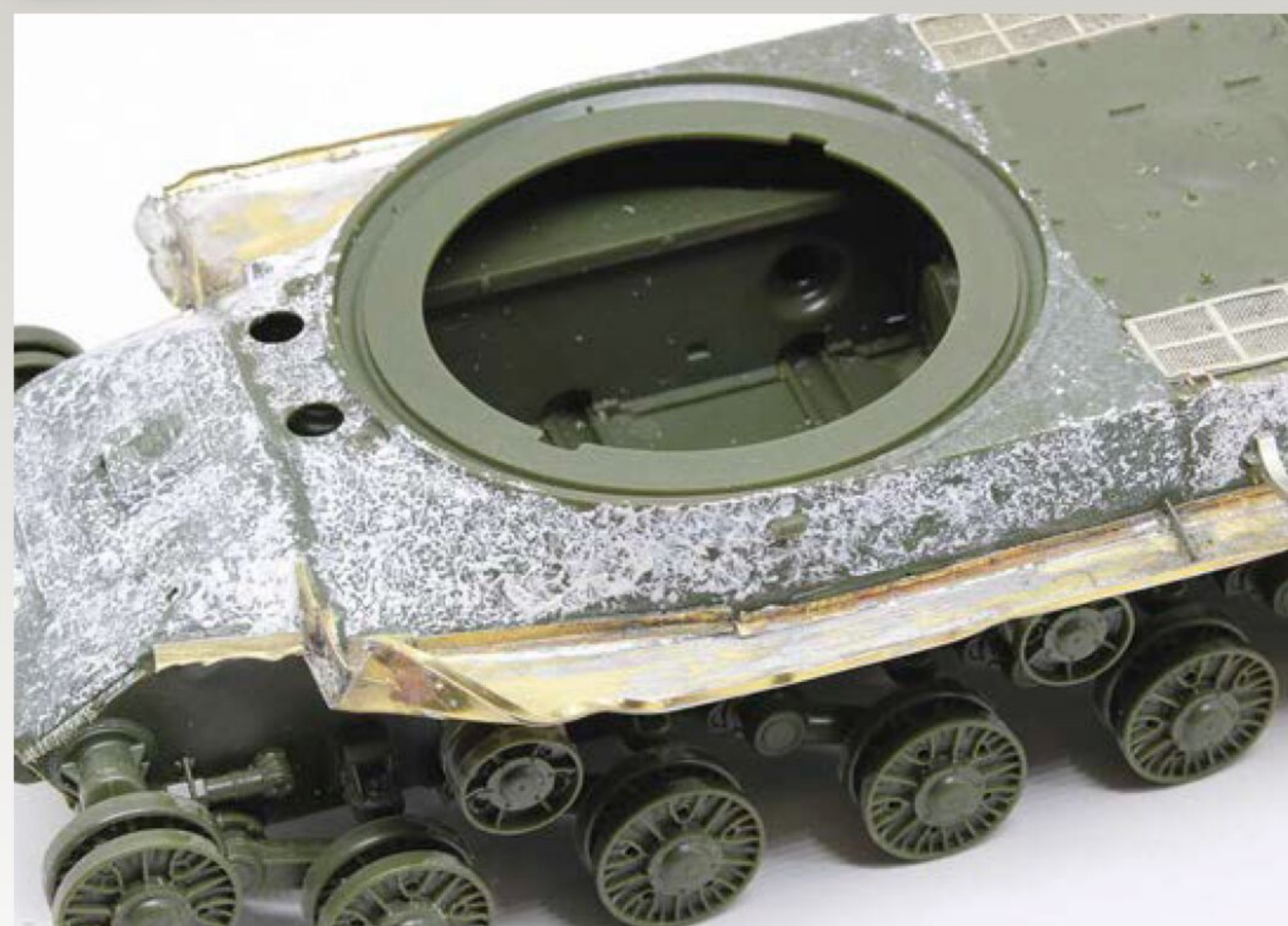
4 Verbogene oder beschädigte Bauteile entstehen am überzeugendsten aus Ätzteilen. Verlötete Verbindungen bleiben auch bei stärkerer Verformung stabil
