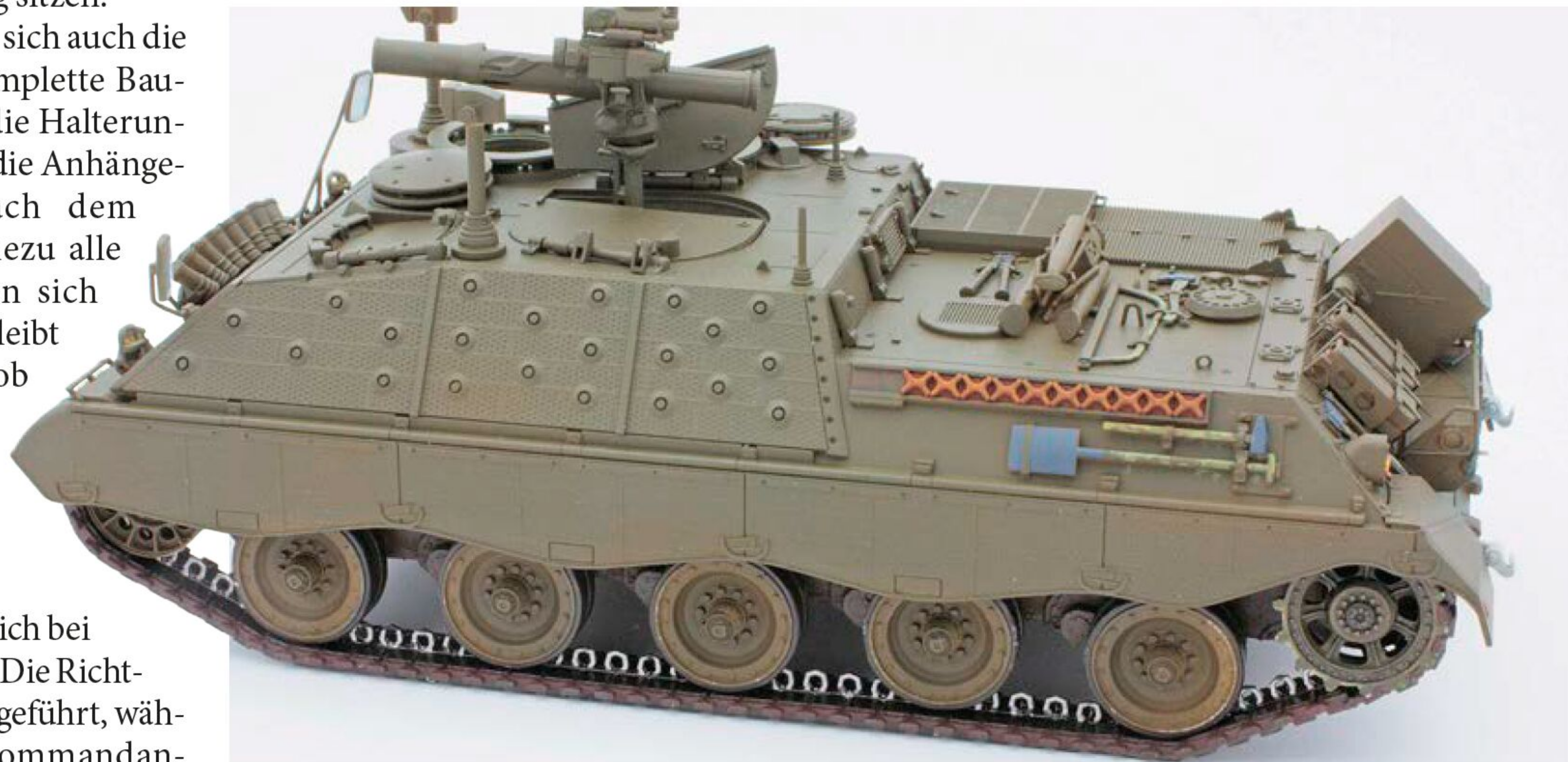
12 Die Halter der Seile greifen über Ober- und Unterwanne. Auch die Abschleppkupplung kommt erst nach dem Verkleben beider Baugruppen an ihren Platz
