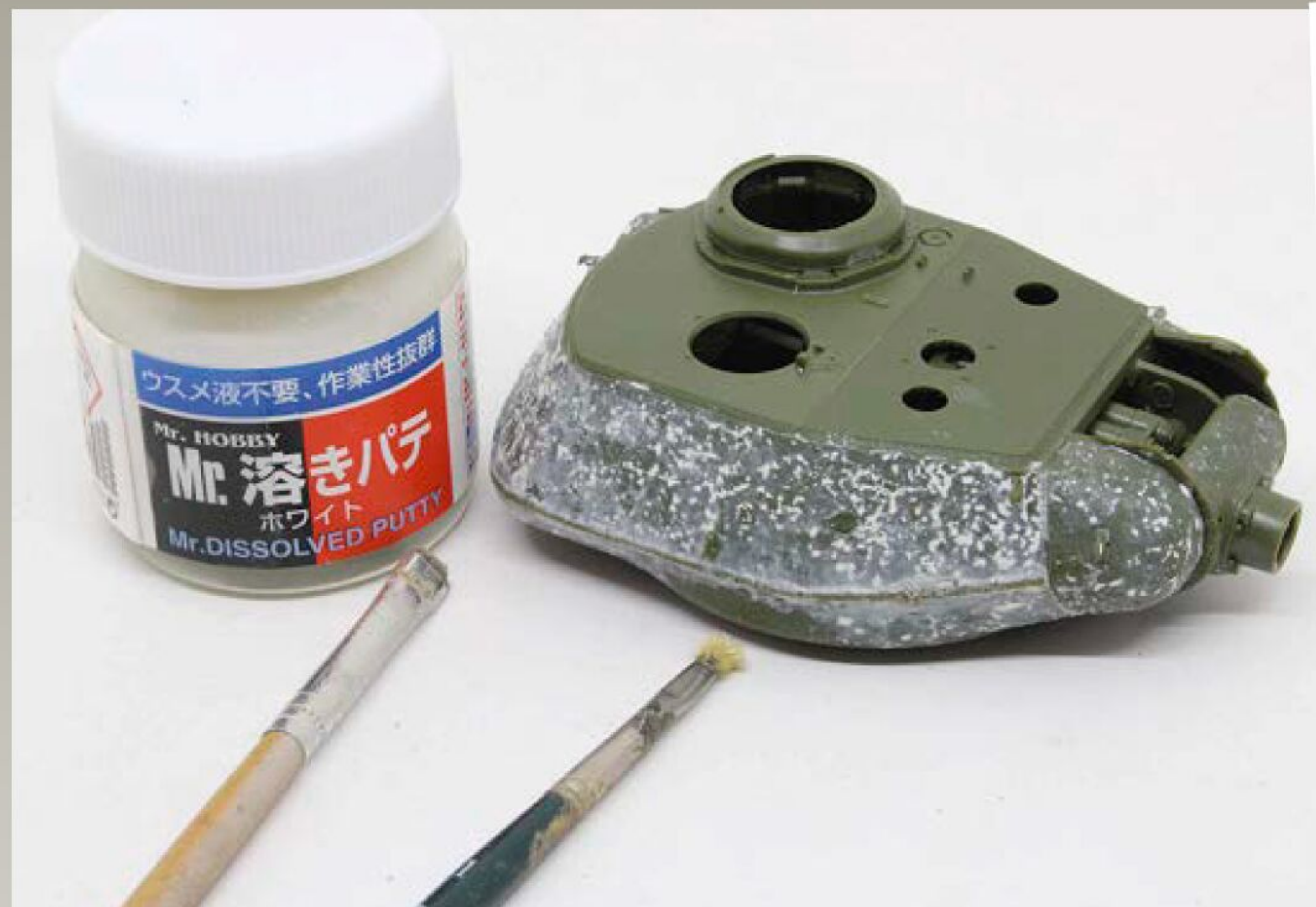
1 Am Turm ist bereits eine Gussstruktur vorhanden. Ein Vergleich mit Originalfotos zeigt jedoch, dass sie etwas kräftiger ausfallen dürfte
