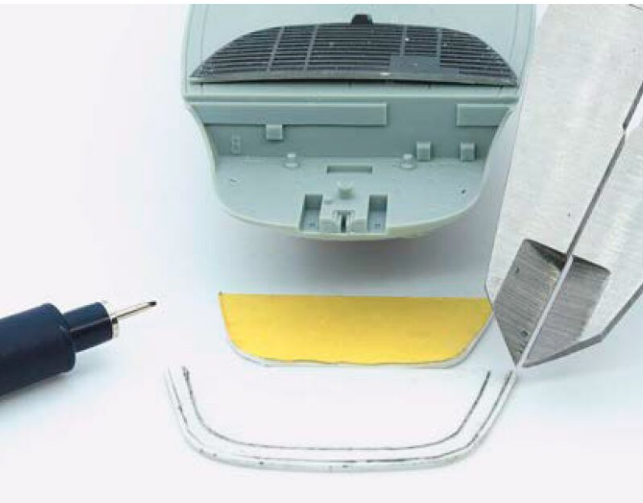
3 Ein Bauteil fällt aus der Reihe: Der Hecküberstand ist verzogen und ließ sich trotz Wärme nicht richten. Abhilfe schafft ein Teil aus Plastik
