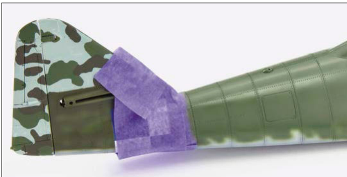
13 Der Rumpf ist ausgehärtet und im Bereich der Sollbruchstelle vorbereitet, sodass RLM 82 aufgetragen werden kann
