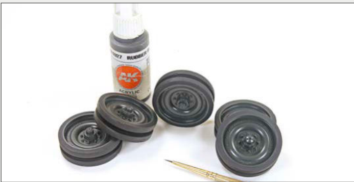
5 Die Gummibereiche der Räder entstehen mit „Rubber Black“-Acrylfarbe und einem feinen Pinsel in mehreren Aufträgen
