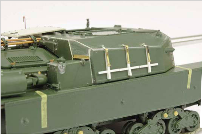
5 Die Schweißnähte im Heckbereich entstanden aus feinen Plastikstreifen. Mit einer scharfen Skalpellklinge erhielt die Oberfläche ihre Struktur
