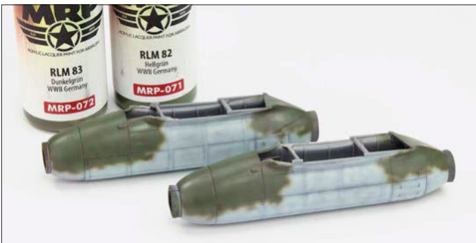
15 Auch die Triebwerksgondeln erhalten eine unregelmäßige Überlackierung in RLM 82 auf der Grundfarbe RLM 81
