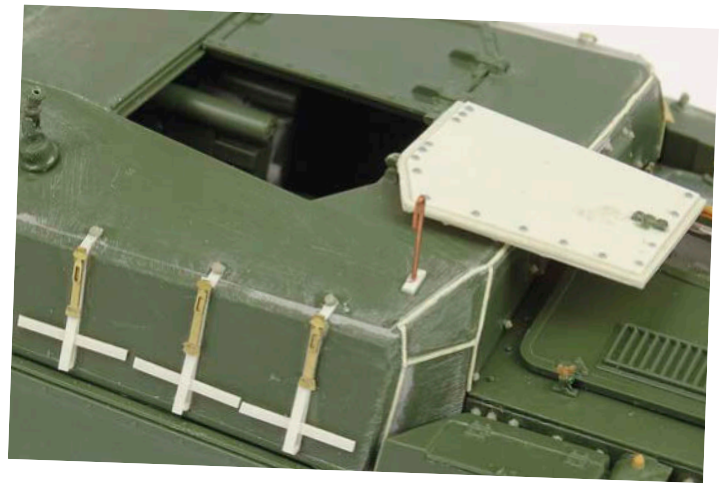
6 Die Dachluken fallen deutlich zu dick aus. Für eine geöffnete Darstellung empfiehlt sich ein Neubau aus dünnem Plastiksheet
