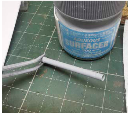
6 Das einteilige Kanonenrohr besitzt lediglich einen dünnen Grat. Mit Spachtelmasse und feinem Schleifpapier entsteht eine saubere Oberfläche
