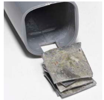
5 Etwa 15 Gramm Blei im vorderen Rumpfbereich verhindern zuverlässig, dass das Modell später als „Tailsitter“ endet
