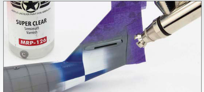
4 Ein seidenmatter Klarlack schützt die Oberfläche für die anstehenden Arbeitsschritte
