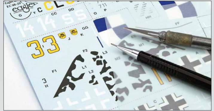
2 Das Decal des Rumpfbandes dient als Vorlage für die Masken. Die Konturen werden mit Pauspapier übertragen
