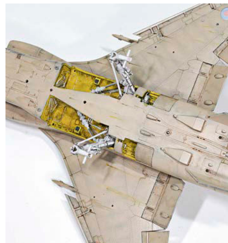
19 Das Fahrwerk wirkt komplex und erhielt zusätzliche Details wie Metallaktuatoren und Leitungen
