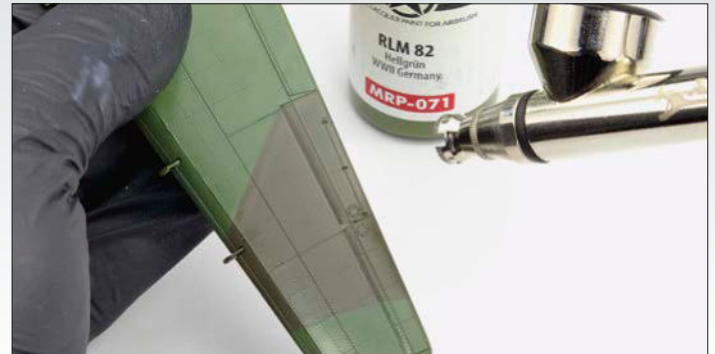
12 RLM 82 entsteht freihändig. Eine ruhige Airbrush-Führung ist entscheidend, alternativ helfen schwebende Masken
