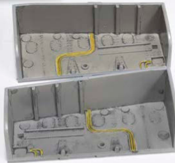
4 Die für damalige Verhältnisse ordentlich gestalteten Fahrwerksschächte erhielten ein dezentes Wash sowie einige farblich abgesetzte Kabel
