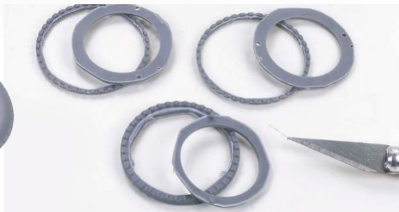
46 Durch starkes Ausdünnen des Materials lassen sich die Reifenkanten später leichter verformen
