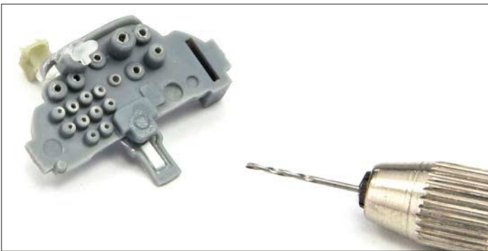
13 Die Gehäuse der Anzeigeinstrumente erhalten Bohrungen für Bleidraht in verschiedenen Stärken
