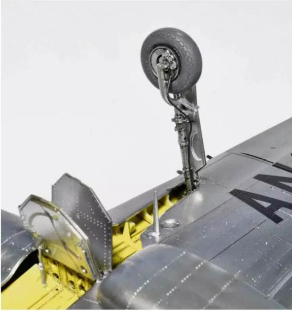
**18** Die flachen Ätzteile der Bremsleitungen sind durch 0,3-mm-Bleidraht ersetzt, was realistischer aussieht
