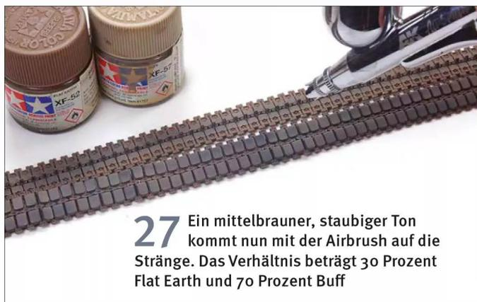
**27** Ein mittelbrauner, staubiger Ton kommt nun mit der Airbrush auf die Stränge. Das Verhältnis beträgt 30 Prozent Flat Earth und 70 Prozent Buff
