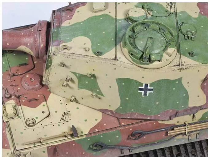
**13** Mit einem dunklen Wash werden nun die Details hervorgehoben. Dort, wo es auf Staub trifft, variiert das Weathering
