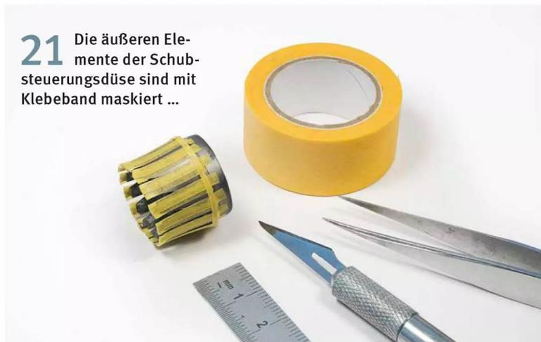
**21** Die äußeren Elemente der Schubsteuerungsdüse sind mit Klebeband maskiert ...
