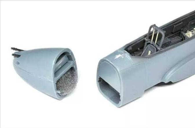
**4** Damit später beim Lackieren kein Sprühnebel ins Cockpit eindringt, kam ein Schwamm im Inneren zum Einsatz
