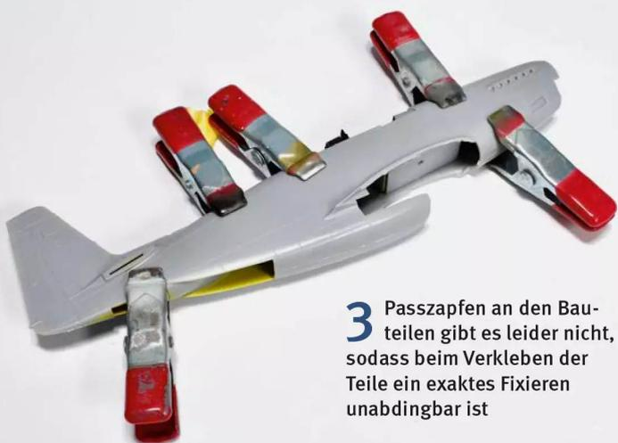
**3** Passzapfen an den Bauteilen gibt es leider nicht, sodass beim Verkleben der Teile ein exaktes Fixieren unabdingbar ist
