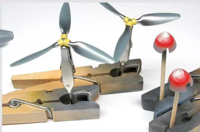
**12** Die Naben der Propeller sind zuerst in Chrom lackiert. Die Spitzen der Spinner bekamen RLM 23
