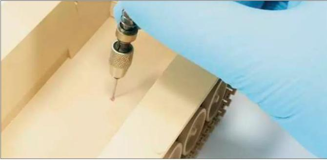
**1** Zuerst wird ein feines Loch auf der Unterseite der Hülle gebohrt. Am besten so, dass es von der Öffnung für den Turm zugänglich ist
