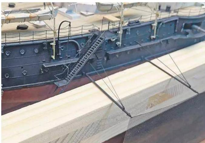
**25** Ein Brettchen hilft bei der Ausrichtung der Torpedonetze. Diese Nervenbelastung hebt man sich besser bis zum Schluss auf
