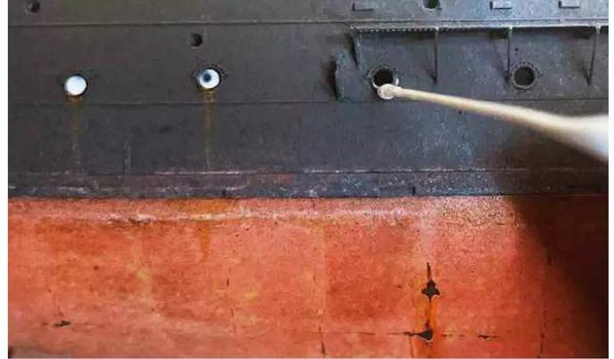
**8** Die Bullaugen werden mit Holzleim verglast. Der Überwasserrumpf zeigt eine fleckig-speckige Struktur und weiße Salzkrusten
