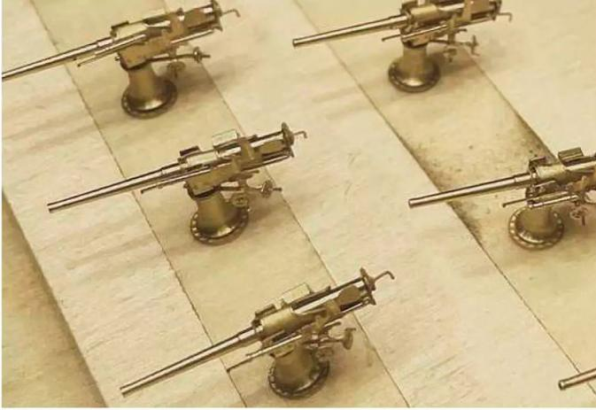
**19** Die Torpedoboot-Abwehrgeschütze sind Pretiosen aus gedrehtem und geätzttem Messing. Allein die Menge geht an die Nerven
