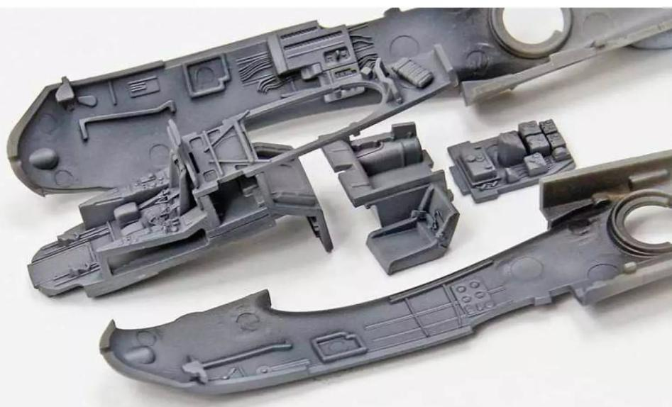
ich gezogenen Gußast, um die Lücken zu schließen (6 und 7). Dieser wird mit Tamiya „Extra thin“ eingeklebt und nach 24 Stunden Aushärtung verschliffen (8).
