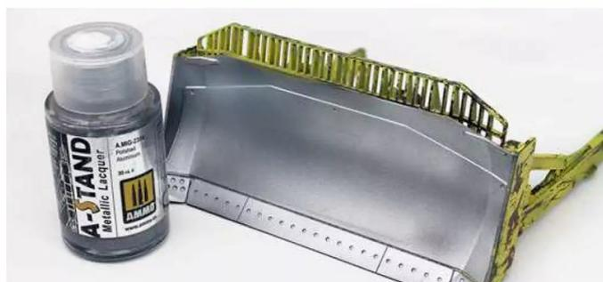
**14** Mit dem Airbrush und Metallic-Lackfarbe besprühte ich den Bereich, der durch die Reibung blank ist und keine Farbe aufweisen darf. Ein Räumschild lebt genau von diesem Effekt
