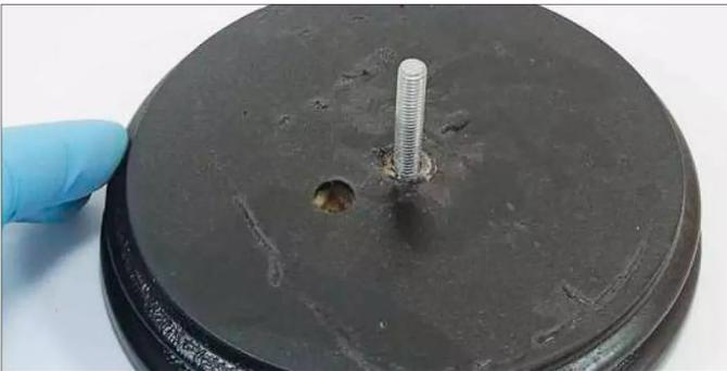
**3** Ein mittelgroßer Schraubbolzen wird in eine Holzunterlage geschraubt. Dieser Schraubbolzen wird später in das zuvor gebohrte Loch im Modell eingesetzt. Die richtige Lochgröße ist wichtig
