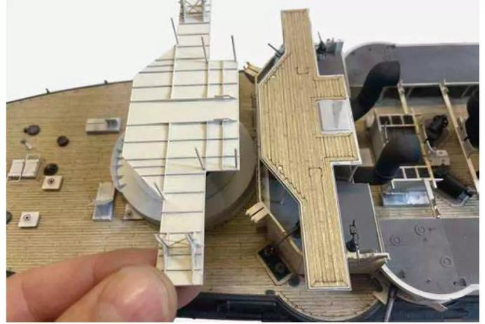
**20** Die beiden Brücken sind mit einer filigranen Unterkonstruktion aus Messingstreifen verfeinert
