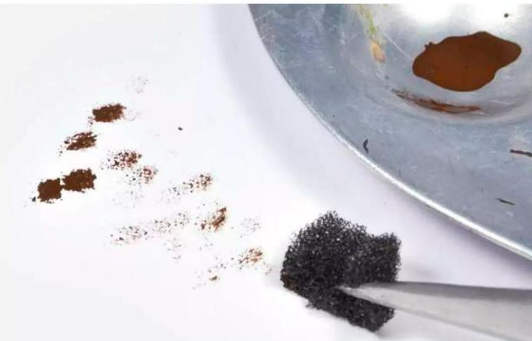
**20** Wenn die Schwammtechnik verwendet wird, muss der Schwamm vorher „entladen“ werden
