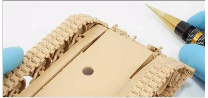
**2** Mit einem Lexanschneider wird das Loch auf den gewünschten Durchmesser erweitert. Ein Metallbohrer geht auch
