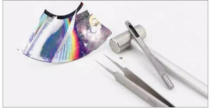
**2** Um die Folienschicht zu separieren, müssen der Rohling in Stücke gebrochen und die runden Spiegelflächen für das Laserzielsuchgerät ausgestanzt werden
