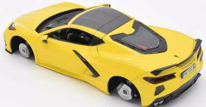
**18** Nach der Hochzeit zwischen Karosserie und Chassis wurden Heckstoßstange und Spoilerlippe angeklebt. Dank guter Passgenauigkeit war nur wenig Druck nötig
