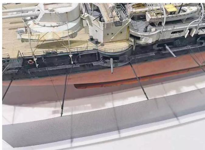
**28** Die Torpedonetze sind in einem Stück aus Messing geätzt und haben schon den richtigen Durchhang
